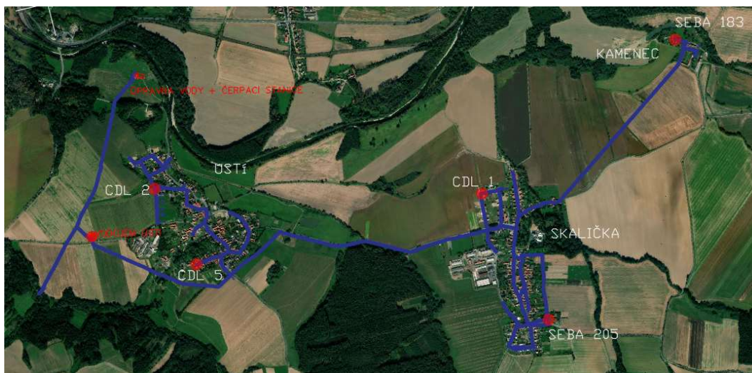
Obrázek 18. Mapa osazení tlakových čidel
