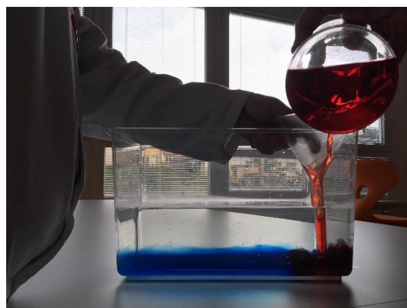
Obr.21: Nalítí teplé vody do nádrže pomocí trychtýře (zdroj: vlastní)
