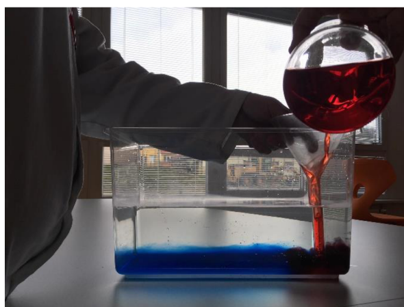
Obr.21: Nalítí teplé vody do nádrže pomocí trychtýře (zdroj: vlastní)
