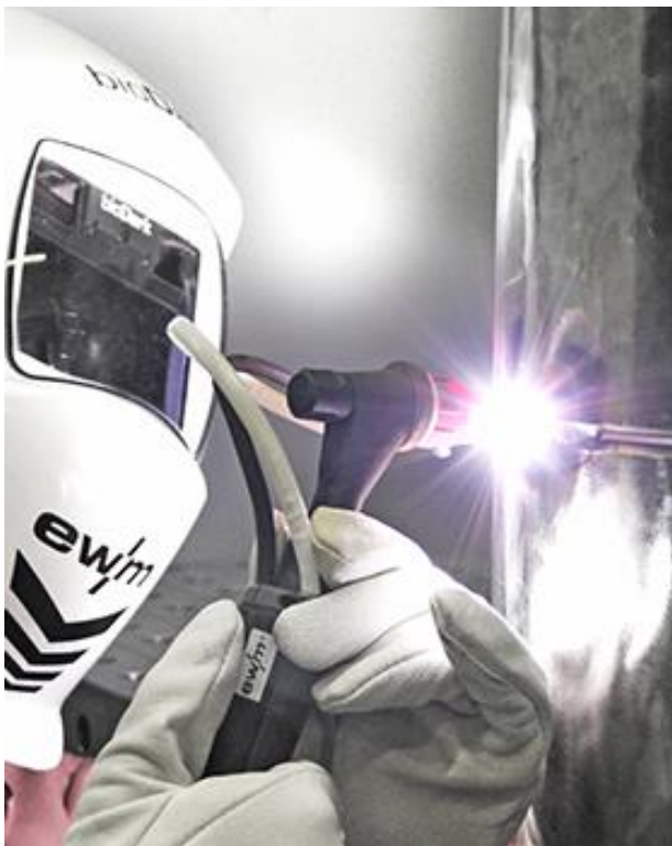
Obr. 1 Svařování s podáváním horkého drátu [6].
