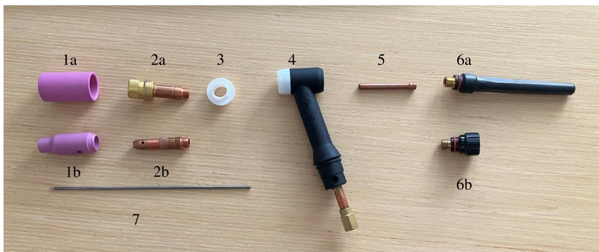
Obr. 5 Díly ručního svařovacího hořáku TIG.
