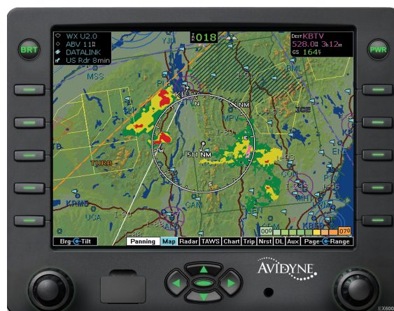
Obr. 2.5: Multifunkčný displej (MFD).
