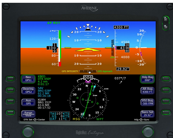
Obr. 2.4: Primárny letecký displej (PFD).
