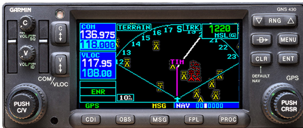
Obr. 2.6: Navigácia Garmin G430, ktorú je možné pripojiť k simulátoru X-plane
