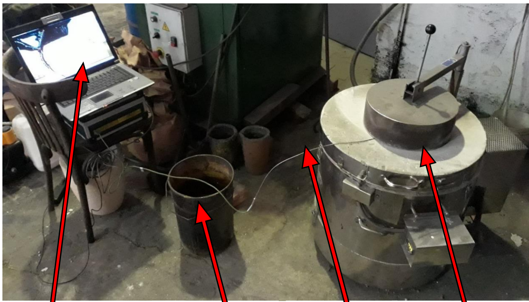
Záznam průběhu teploty Nádoba s vodou Termočlánek Elektrická odporová pec
