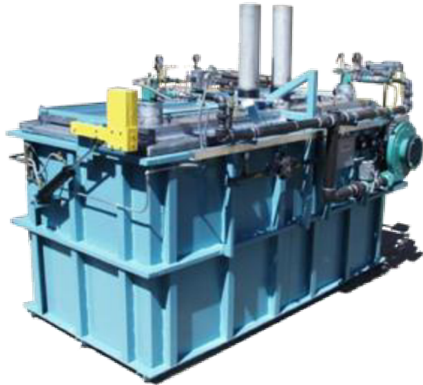
Obr. 25 Pec využívající solné lázně [30]
