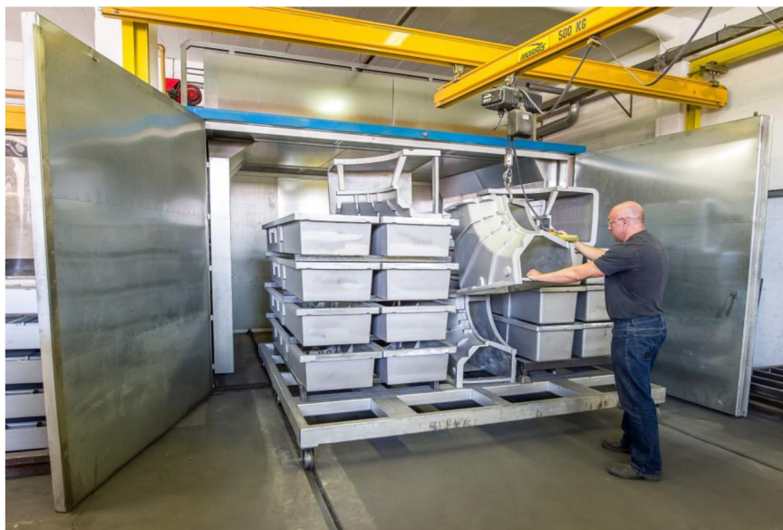
Obr. 26 Vkládání odlitků do pece s normální atmosférou [31]
