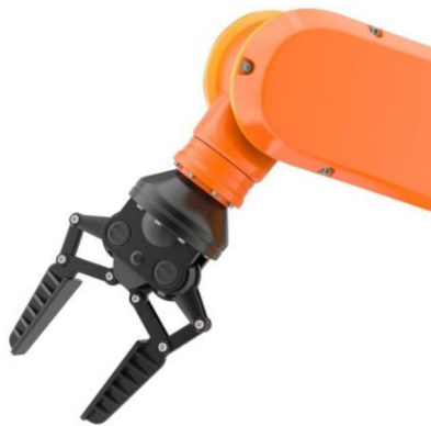
Obr. 6 Aktívny mechanický úchopný prvok [25]
