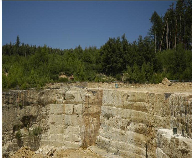
Obr. 29 Lomová stěna v Podhorním Újezdě, na které jsou patrné stopy po blokové těžbě klínováním pomocí odvrtů.
