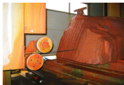
Obr. 14 Speciální lano lanové pily řezající červený pískovec
