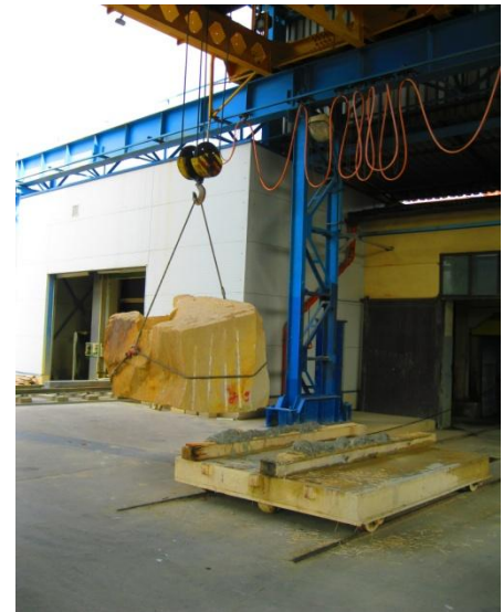
Obr. 8 Přeprava vytěženého bloku kamene mostovým jeřábem. Blok se umísťuje na pojezdový vozík dělicí pily.
