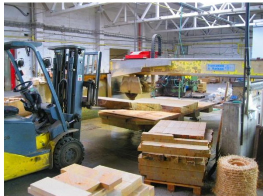
Obr. 10 Přeprava hořického pískovce vysokozdvizným vozíkem. Navážka na stůl mostové kotoučové frézy FB.
