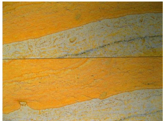
Obr. 2 Hořický pískovec - pestré zbarvení způsobuje příměs železa, černý pruh jsou usazené saze. Na obrázku jsou nařezané obkladové desky.
