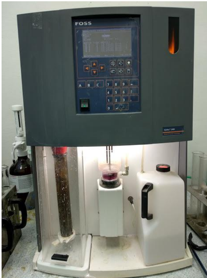
Obr. 12 Stanovení obsahu dusíkatých látek na přístroji Kjeltec 2400 (Foss) (vlastní foto)
