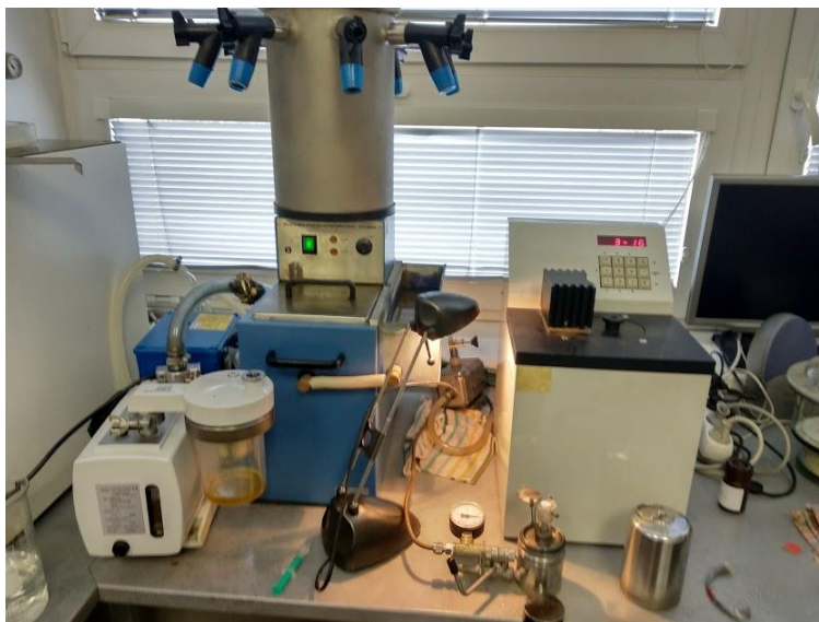
Obr. 13 Stanovení brutto energie na kalorimetru Laget MS 10-A (vlastní foto)
