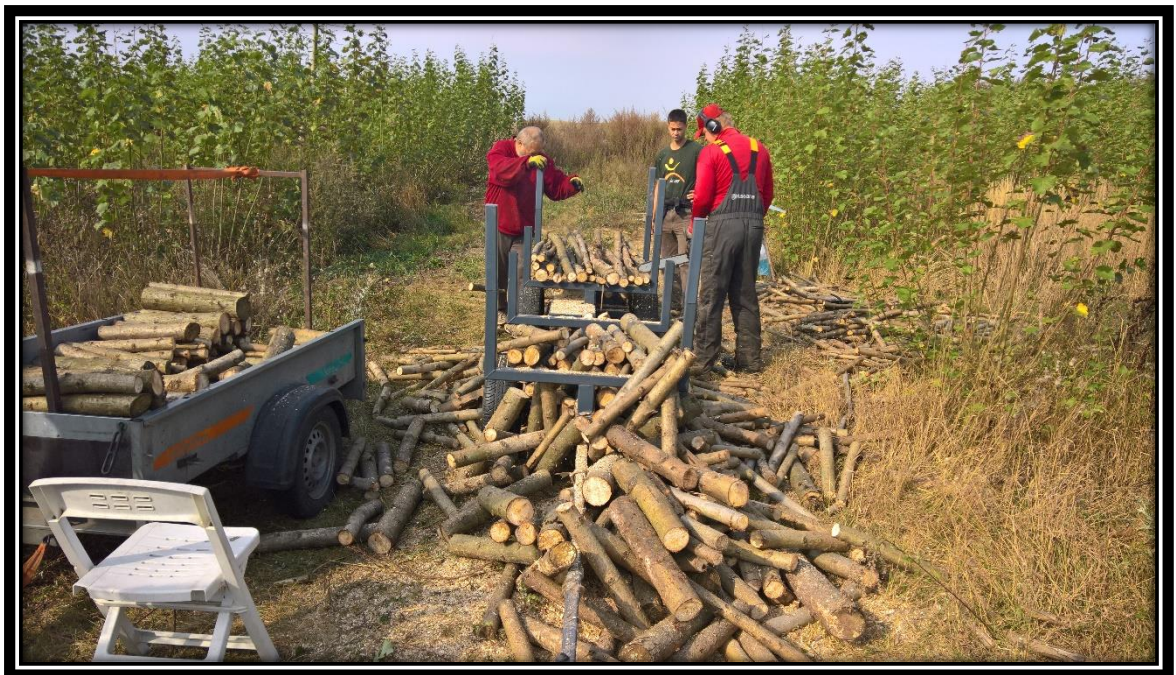
Přil. 4 Způsob vykládání, který byl prováděn současně s krácením kmenů u stroje ESD 800
