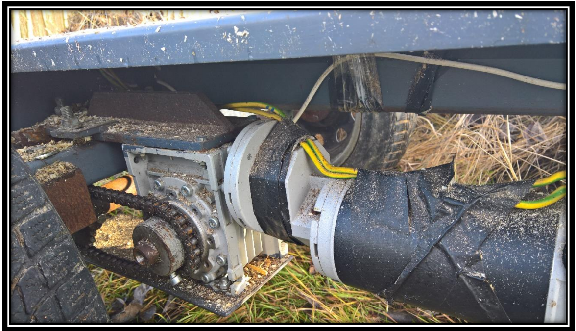
Příl. 1 Bližší pohled na elektromotor stroje ESD 800
