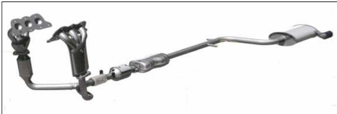
Obrázek 6: Výfukový systém osobního automobilu
