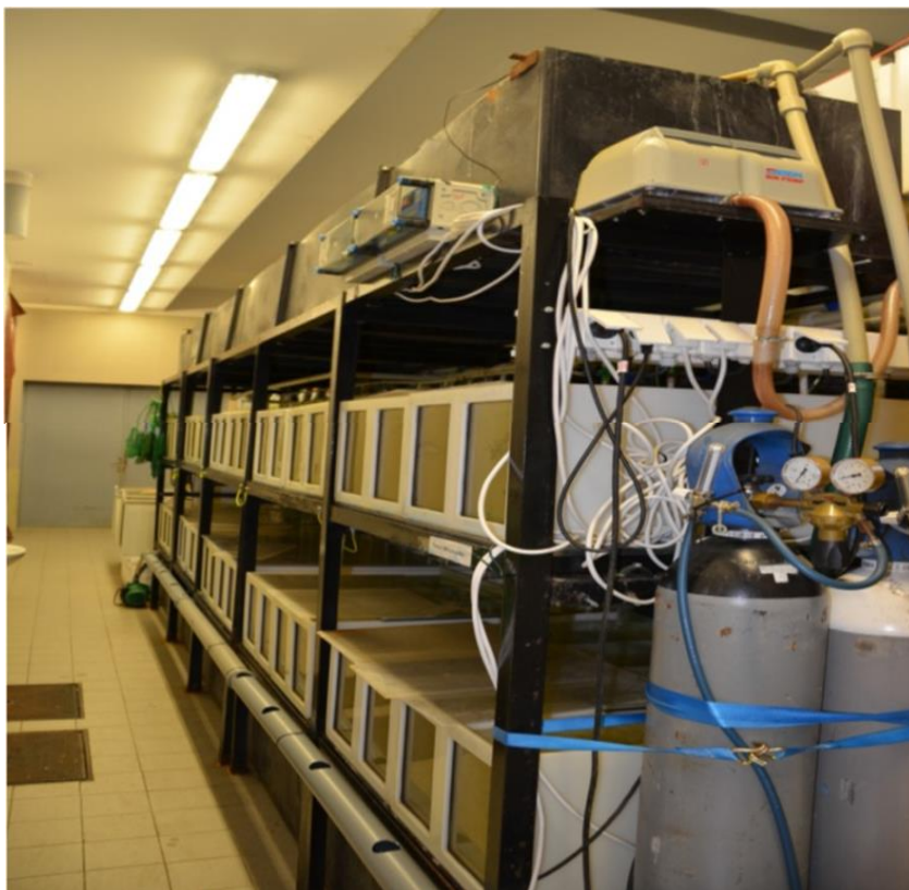
Obr. č. 3 Pohled na jednotlivé odchovné nádrže a recirkulační systém
