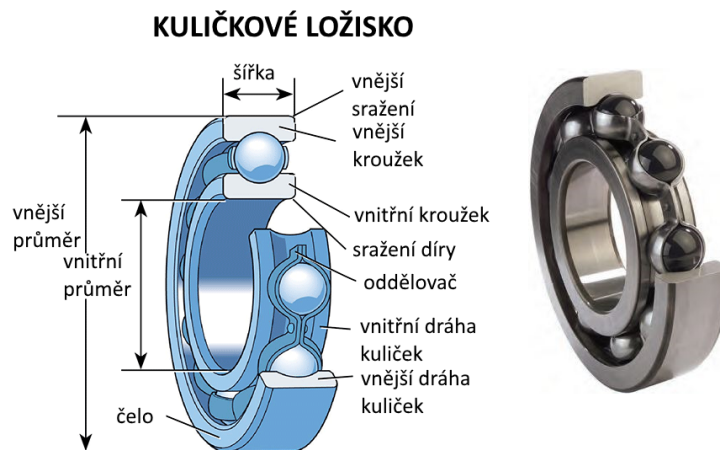
Obr. 2.1: Schéma valivého ložiska [22]
