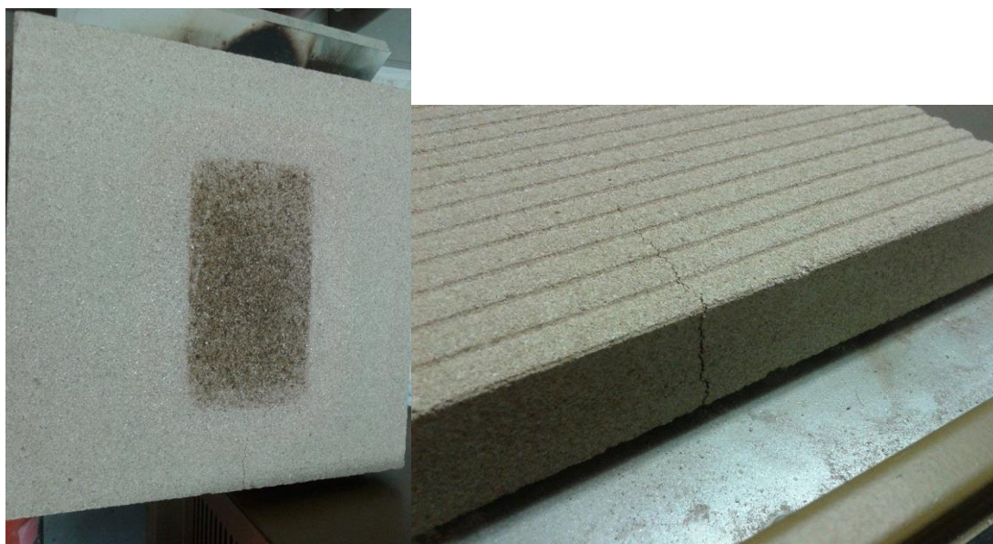
Obrázek 33: Grenaisol tl. 40 mm po testování žárem s viditelnou prasklinou uprostřed
