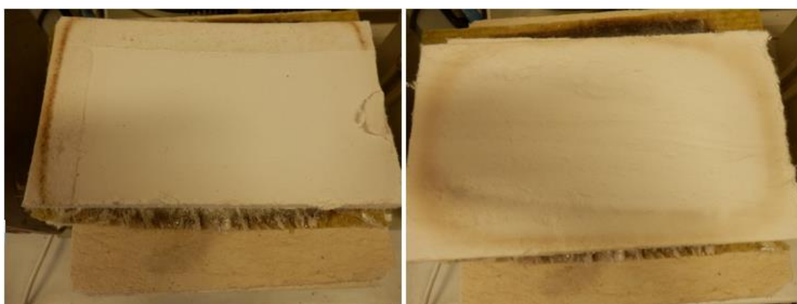
Obrázek 50: WDS® High, tl. 15 mm - spodní vrstva v přímém kontaktu se žářem, po testování
