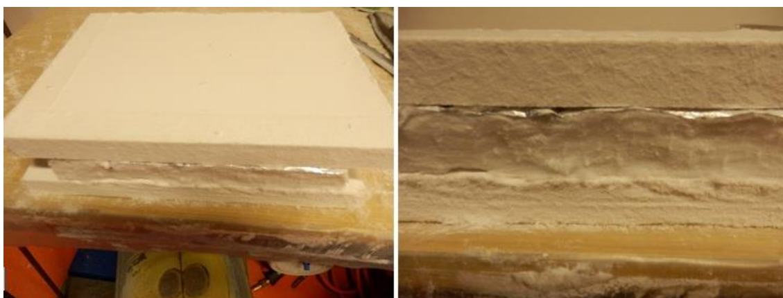
Obrázek 53: Vrstvené složení, tl. 60 mm – před testováním
