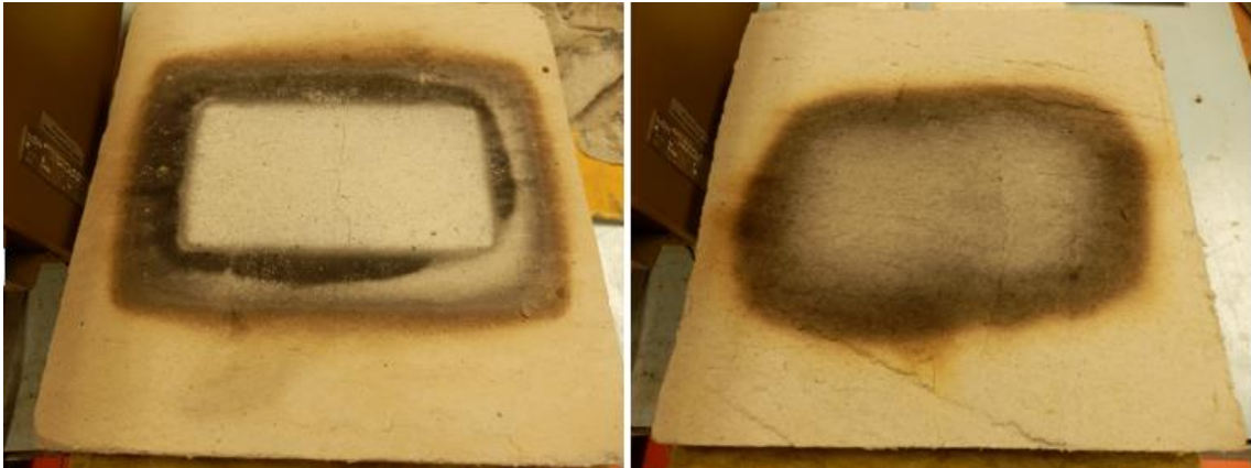
Obrázek 46: Deska FireMaster®350board, tl. 20 mm – spodní vrstva v přímém kontaktu se žářem, po testování
