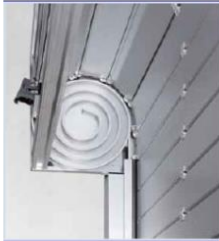
Obrázek 3: Spirálový mechanismus vrat pro bezkontaktní uložení lamel
