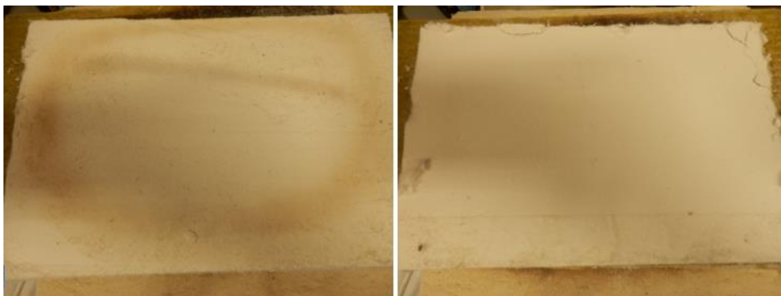
Obrázek 52: WDS®High tl. 15 mm – horní vrstva, po testování
