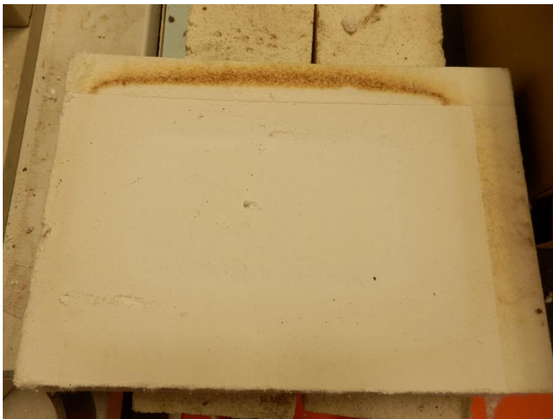
Obrázek 37: WDS® High tl. 30 mm po testu žárem
