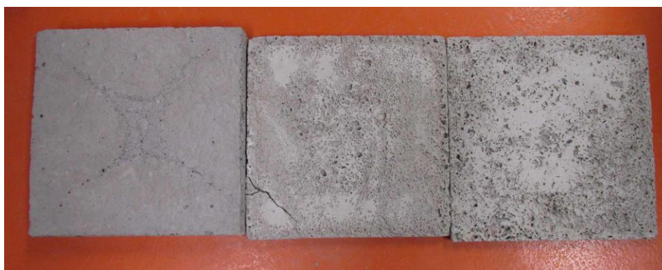
Obrázek 35: Geopolymer o tloušťkách 10, 25, 50 mm. Vzorky byly předsušeny při 100 °C.
