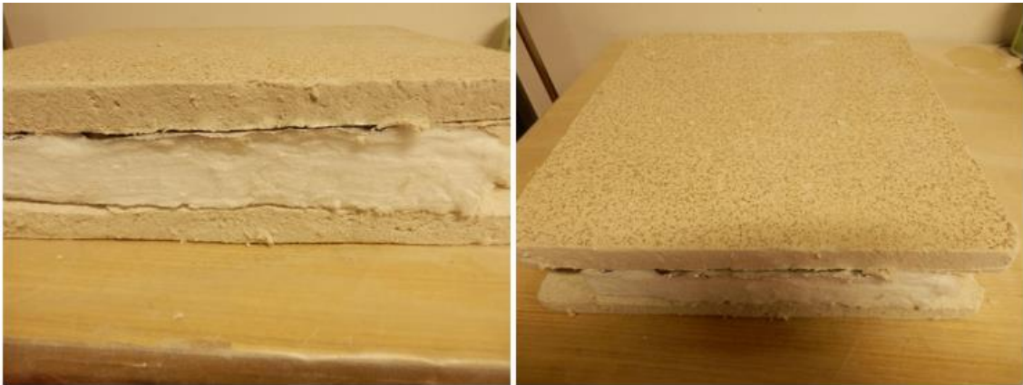
Obrázek 41: Skládané složení, celková tloušťka 60 mm – před testováním
