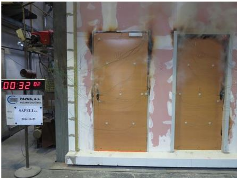
Obrázek 13: Probíhající test protipožárních dveří (7)
