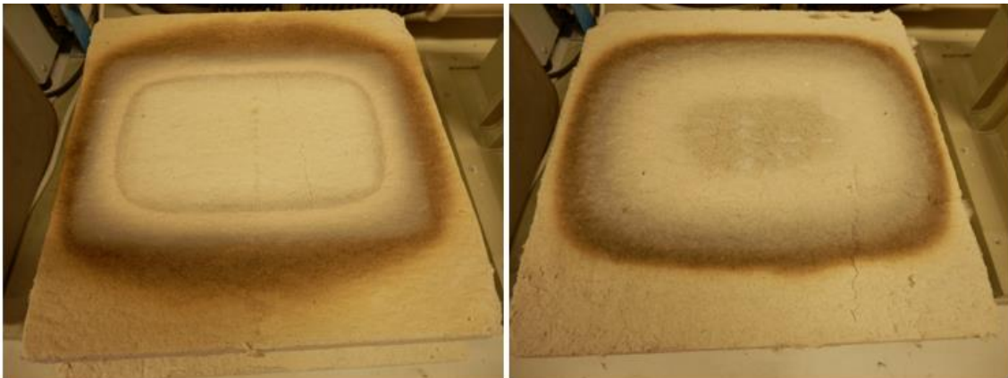
Obrázek 42: Deska FireMaster®350board, tl. 20 mm – spodní vrstva v přímém kontaktu se žářem, po testování
