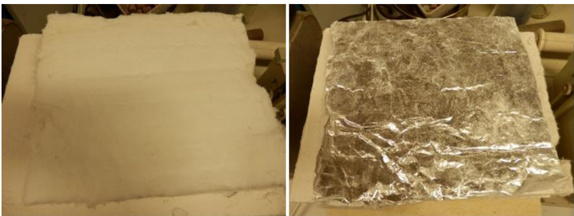
Obrázek 55: FireMaster® Marine Plus Blanket, tl. 40 mm – prostřední vrstva, po testování
