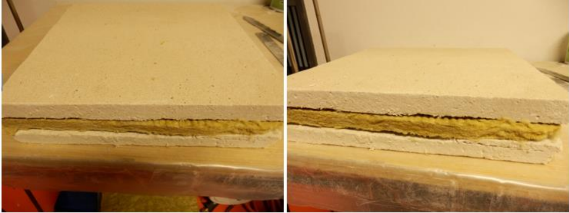
Obrázek 45: Vrstvené složení, tl. 60 mm – před testováním
