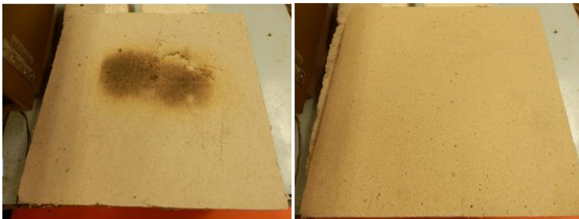
Obrázek 48: FireMaster®350board tl. 20 mm – horní vrstva, po testování
