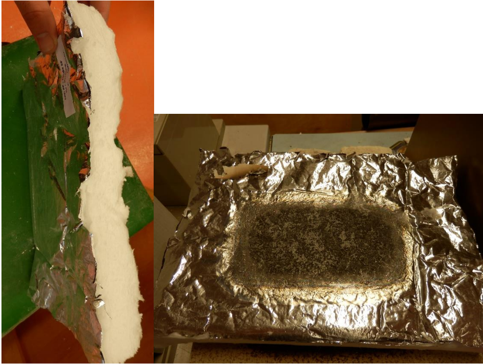
Obrázek 39: FireMaster® Marine Plus Blanket – a) z boku, b) po testu žárem
