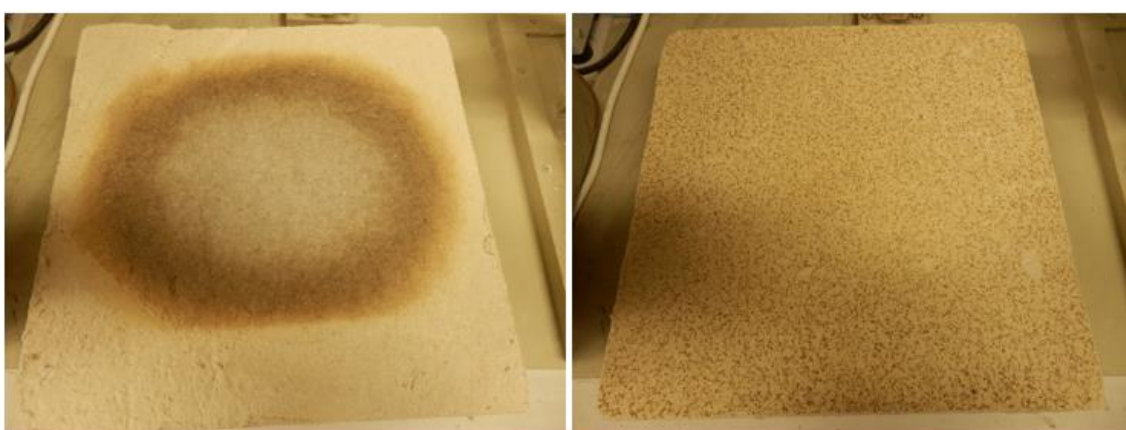
Obrázek 44: FireMaster®350board tl. 20 mm – horní vrstva, po testování
