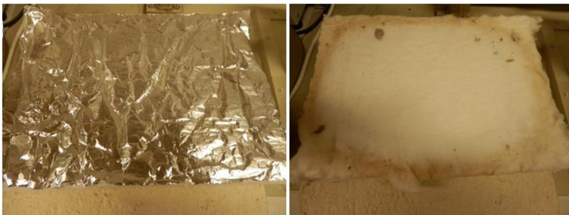
Obrázek 43: FireMaster® Marine Plus Blanket, tl. 40 mm – prostřední vrstva, po testování
