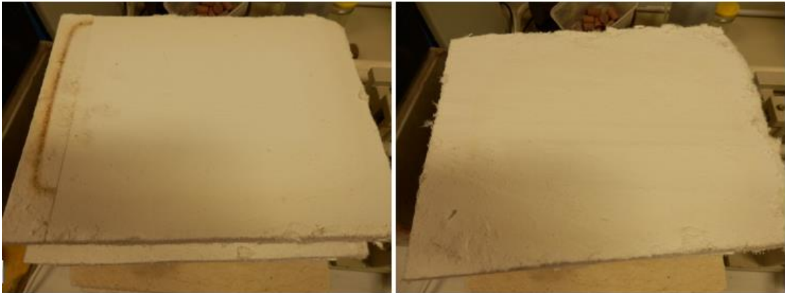
Obrázek 54: WDS® High, tl. 20 mm - spodní vrstva v přímém kontaktu se žářem, po testování
