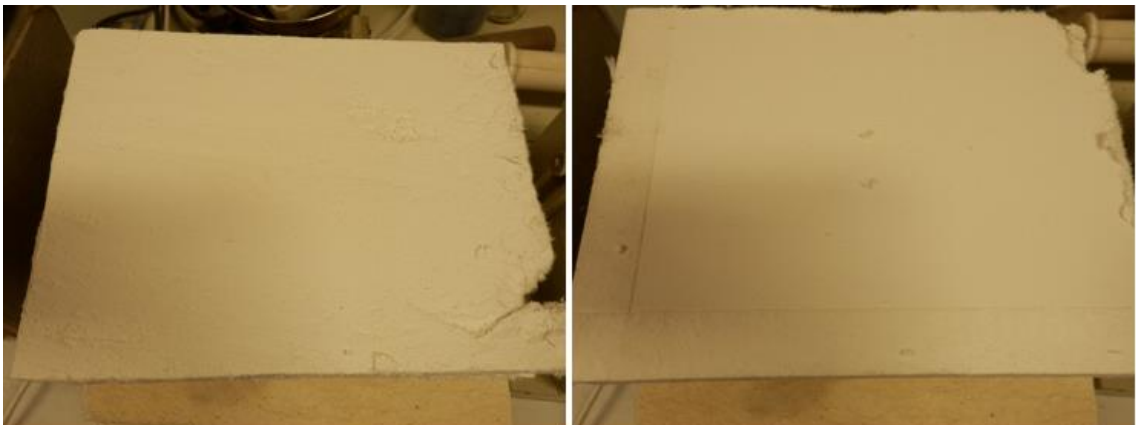
Obrázek 56: WDS® High tl. 20 mm – horní vrstva, po testování
