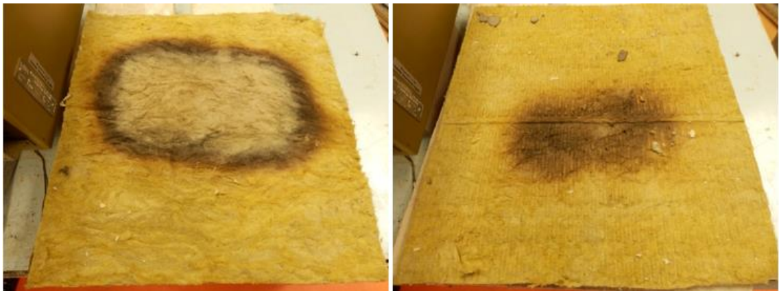
Obrázek 47: Isover FireProtect 150, tl. 20 mm – prostřední vrstva, po testování
