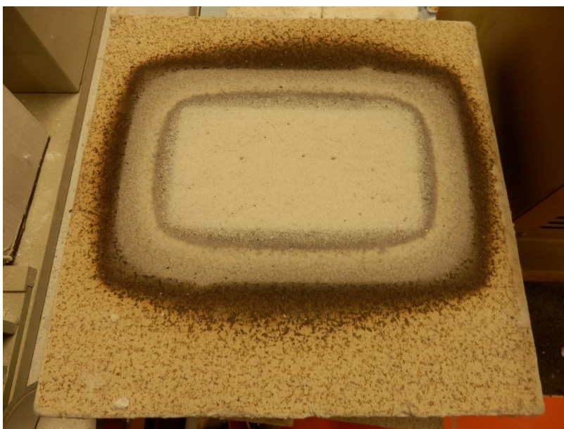
Obrázek 38: FireMaster® tl. 40 mm po testu žárem
