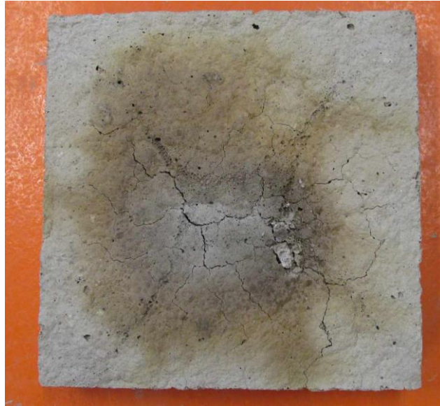
Obrázek 36: Geopolymer po testování, znatelné trhliny
