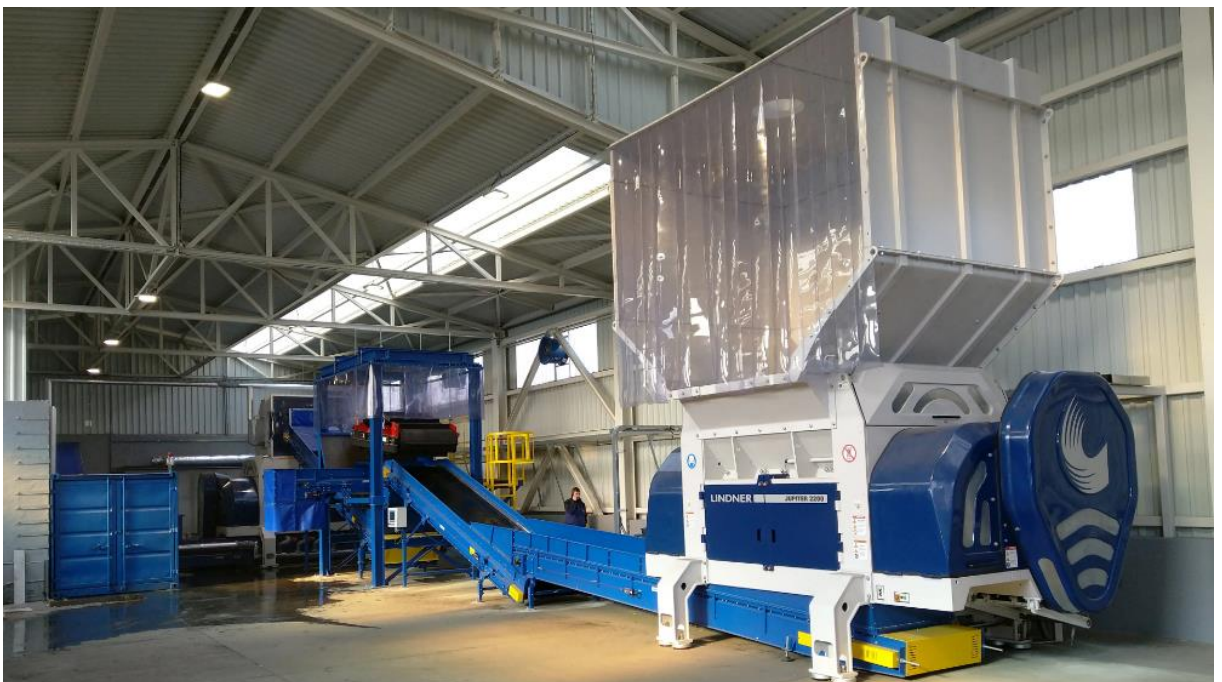
Obrázek 11 TAP linka k výrobě alternativního paliva
