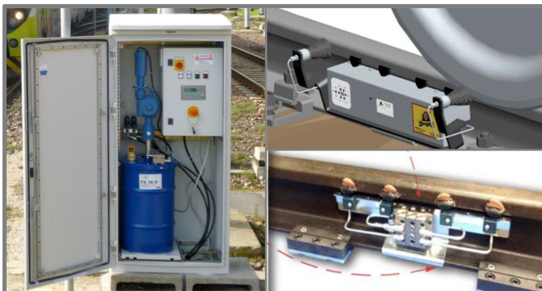
Obr. 3-28 DROPSA Track Lube vlevo skříň s technologií, vpravo aplikační lišta [48]
