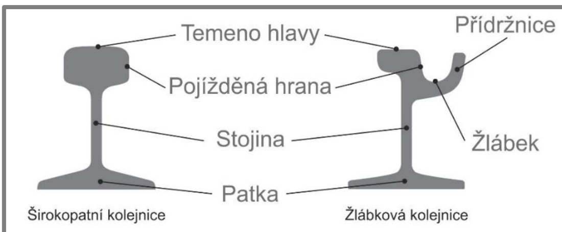
Obr. 3-1 Popis částí širokopatní a žlábkové kolejnice [12]
