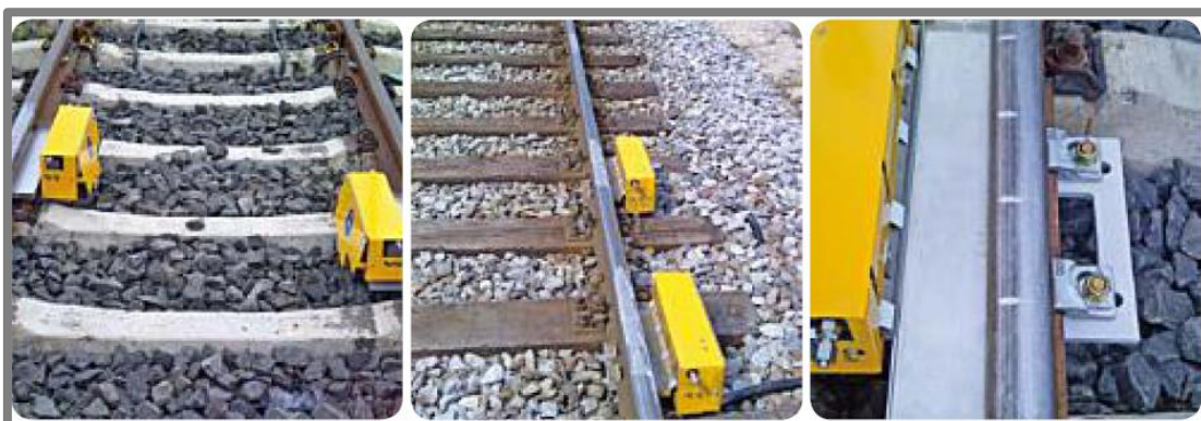
Obr. 3-11 Aplikační jednotka SLID a její instalace na kolejnici [24]
