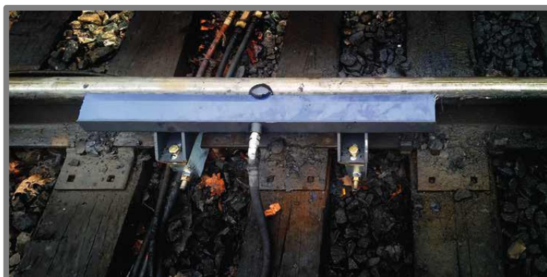
Obr. 3-16 Mazací lišta PolyTOR od společnosti Whitmore [29]
