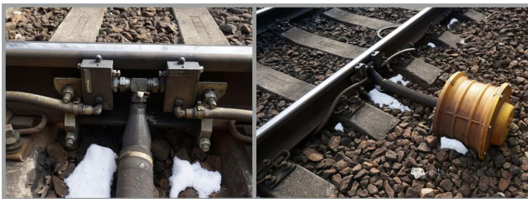
Obr. 3-17 Zařízení LUBRICURVE EasiPump vlevo a LUBRICURVE 50 vpravo
