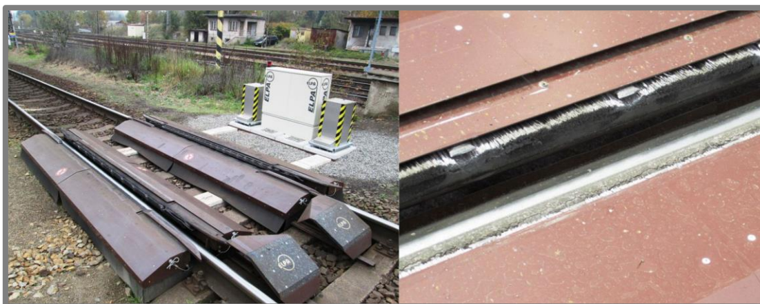
Obr. 3-23 ELPA BREMEX-ANNSYS mazací zařízení určené pro kolejové brzdy [40]
