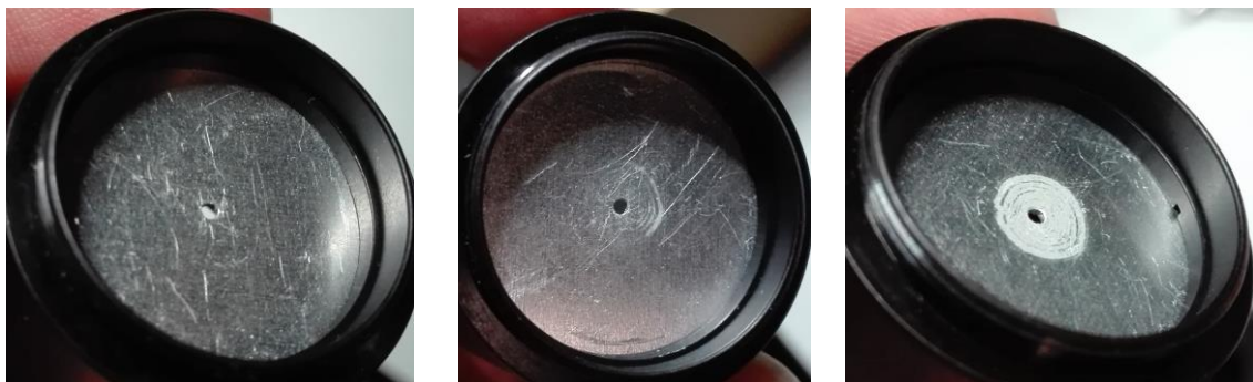
Obrázek 18: Porovnání poškození hliníkového stínítka po vystavení 0 mJ, 2 mJ a 5,5 mJ energie laserového paprsku
