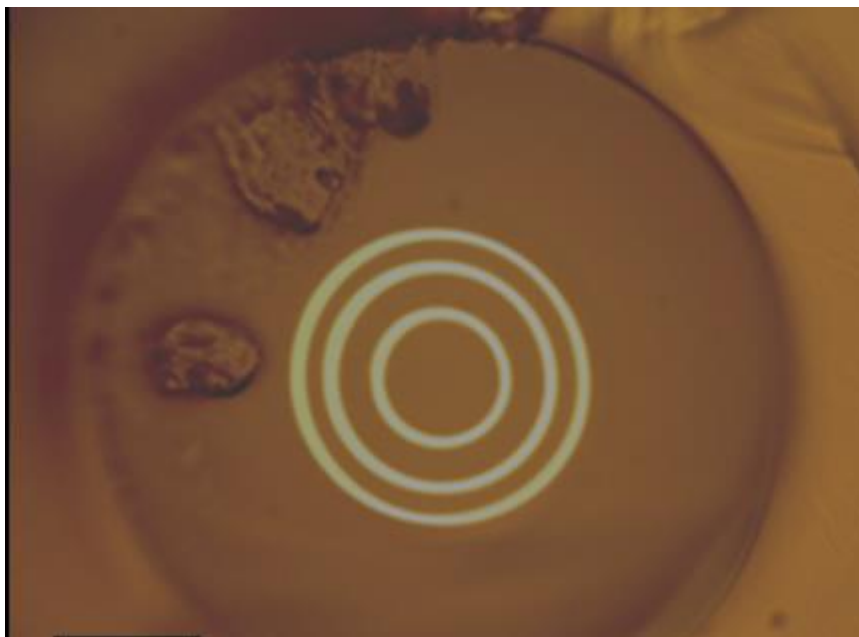
Obrázek 7: Průřez Braggovským vláknem se skelným jádrem [15]
