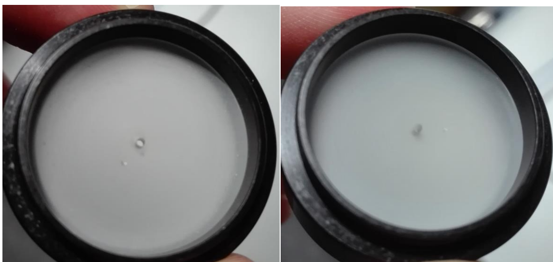
Obrázek 19: Porovnání poškození difusoru po vystavení 0 mJ a 5,5 mJ energie laserového paprsku
