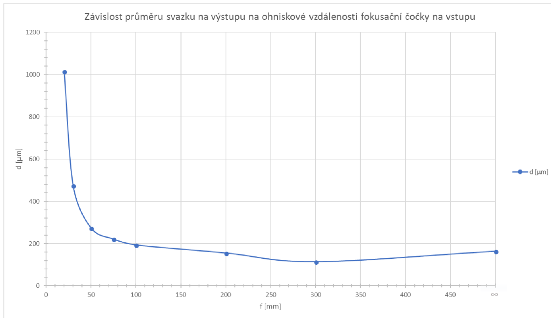
Obrázek 16: Graf závislosti průměru svazku na ohniskové vzdálenosti fokusační čočky
