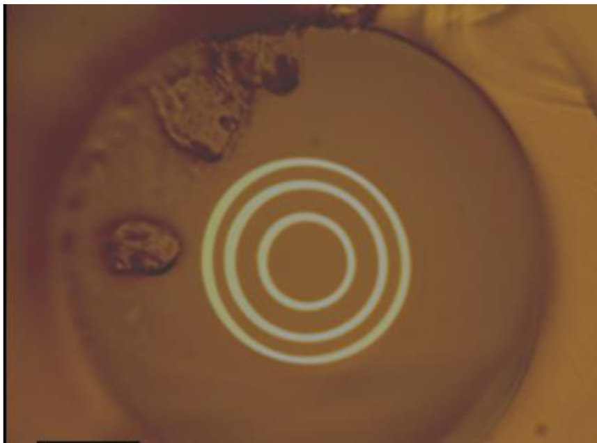
Obrázek 7: Průřez Braggovským vláknem se skelným jádrem [15]
