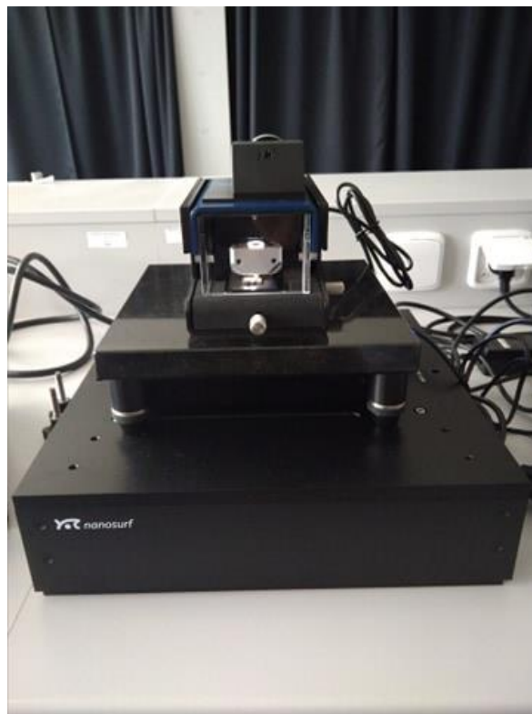
Obrázek 3.1.1. - Mikroskop Compact AFM na antivibrační podložce
