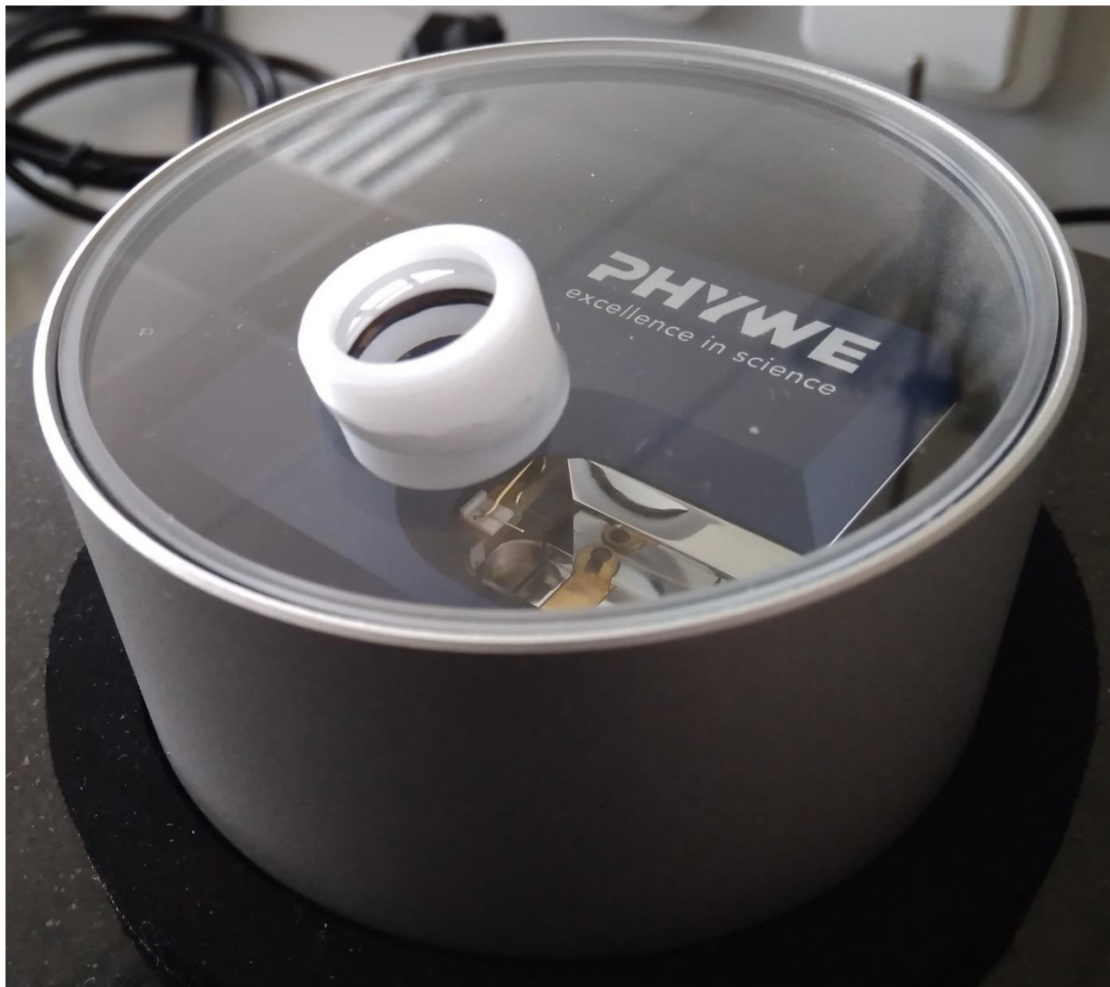
Obrázek 3.4.1. – Skenovací tunelový mikroskop CompactSTM od firmy PHYWE
