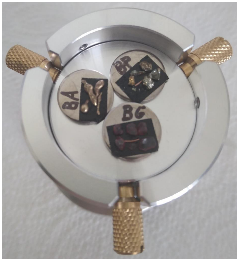
Obrázek 3.6.1. – Mineralogické vzorky, upevněné v držáku, připravené pro měření s elektronovým mikroskopem
