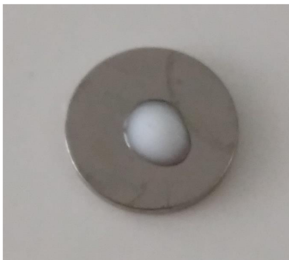
Obrázek 3.7.1. – Kapička disperzního lepidla na bázi polyvinylacetátu na magnetické podložce do AFM
