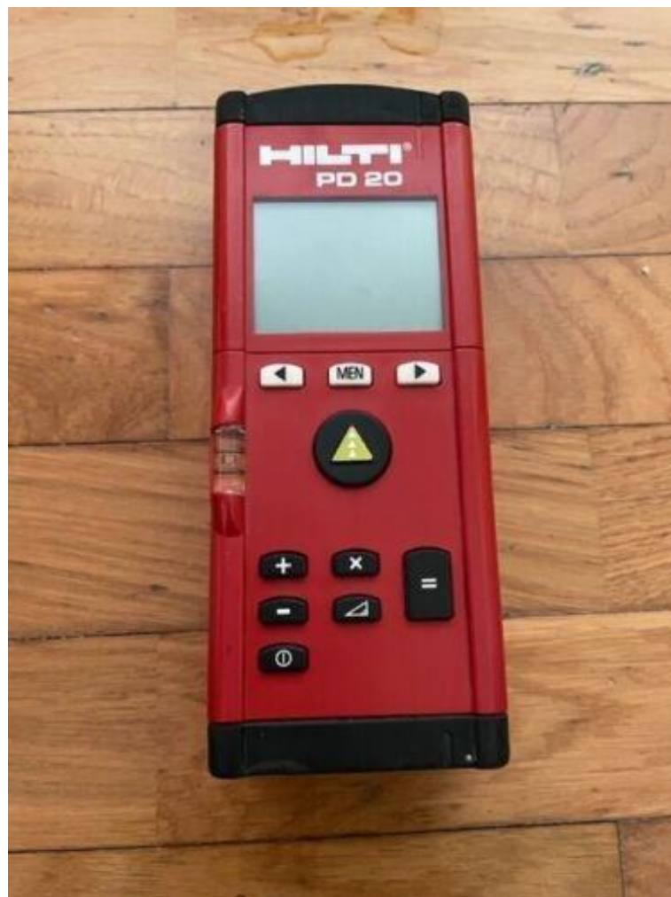
Obrázek 3 Pohled na laserový dálkoměr tov. zn. Hilti PD 20
