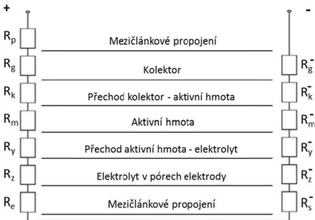
Obrázek 4 - složky vnitřního odporu akumulátoru [4]
