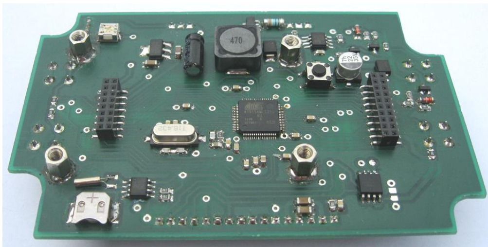
Pozn. Řídicí deska (pohled ze strany součástek)
