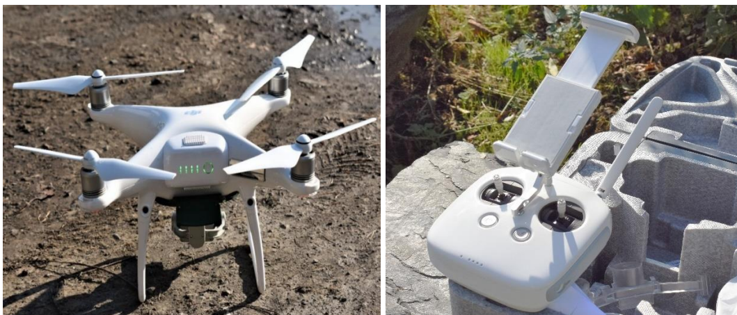
Obr. 10: DJI Phantom 4 Pro s pozemní řídicí jednotkou (zdroj: vlastní tvorba)
