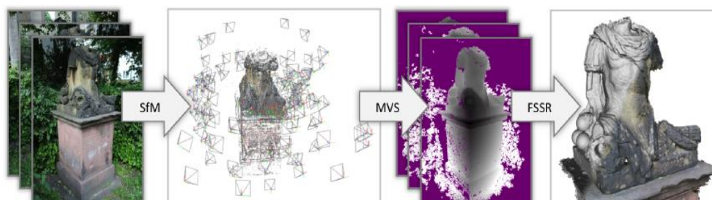
Obr. 6: Průběh algoritmů SfM a Multi-View Stereo (zdroj: Fuhrmann a kol., 2014)
