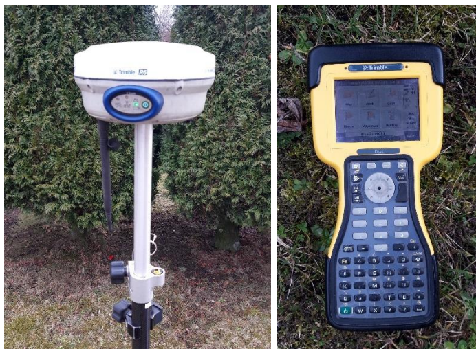
Obr. 9: Trimble R6-2 a Controller TCS2 (zdroj: vlastní tvorba)
