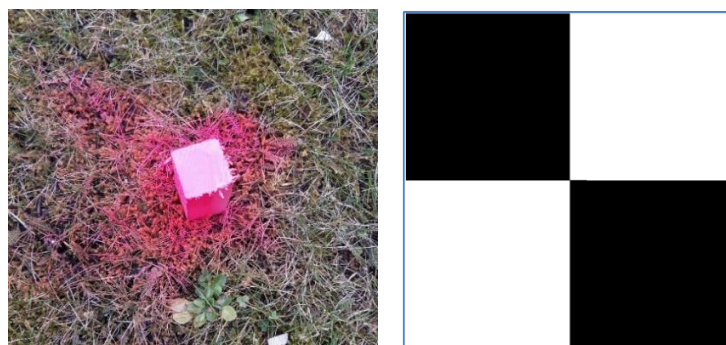
Obr. 17: Značení vlíčovacích bodů a terč (zdroj: vlastní tvorba)
