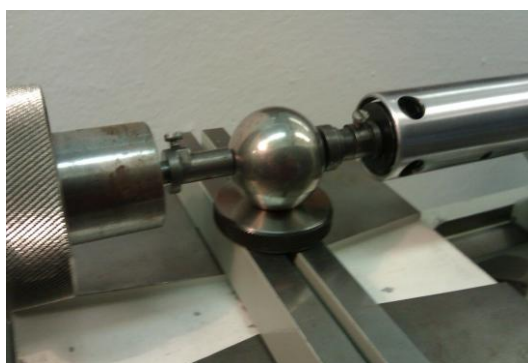
Obr.105 Detail měření kuličky. 157
