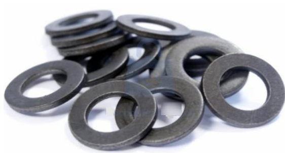
Obr. 79. Výsledné podložky vylisované z lisovacího stroje.
