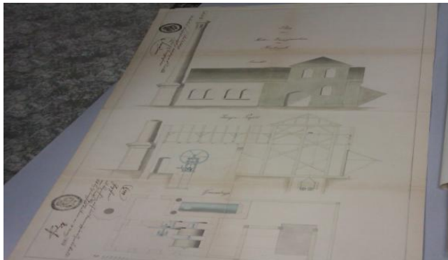
Obr. 34 Tovární budova (nárys a půdorys). Text psán psacím. (Státní okresní archiv Trutnov). Výkres přizpůsobený formátu – nezapomenout zapsat poměr zmenšení – měřítko M 1:50 atd. 71
