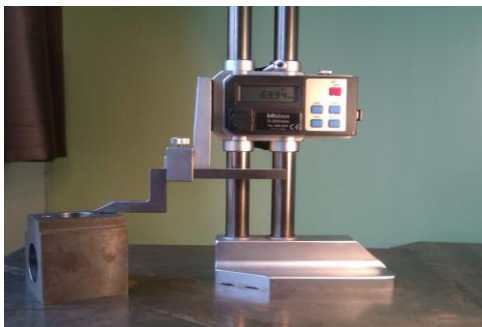
Obr.111 Ukázka měření obrobku digitálním výškoměrem. 158
