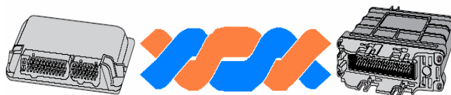
Obr.3.1 Dvou vodičové propojení řídicích jednotek
