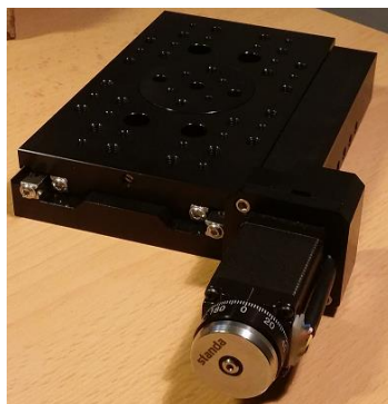
Obr. 1.5 Lineární posun Standu 8MT167-100C28
