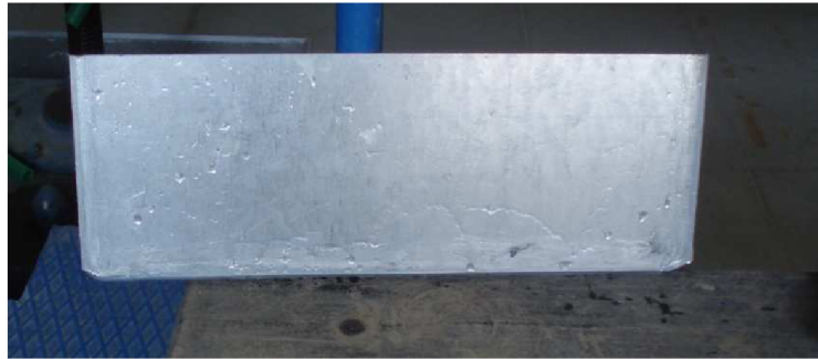
Obrázek 27: Obdélníkový přeliv bez kontrakcí
