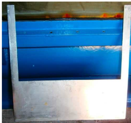
Obrázek 28: Obdélníkový přeliv s kontrakcí
