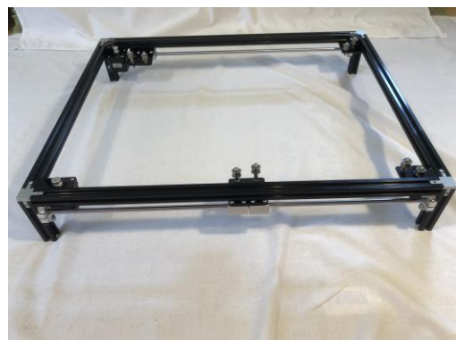
Obrázek 10: Namontované vodící tyče
