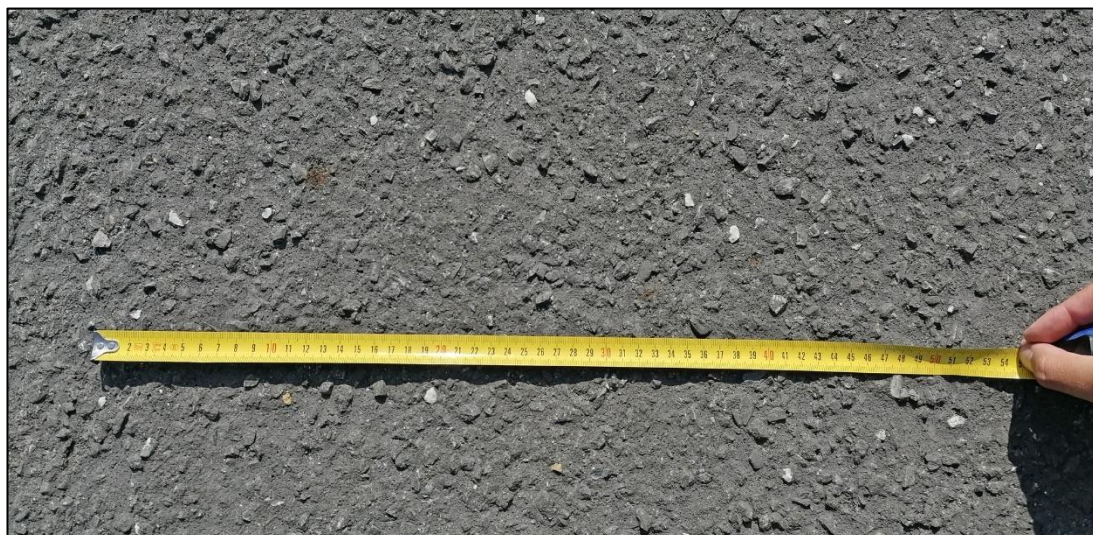
Obrázek 16: Detail povrchu zkušební dráhy – hrubý povrch
