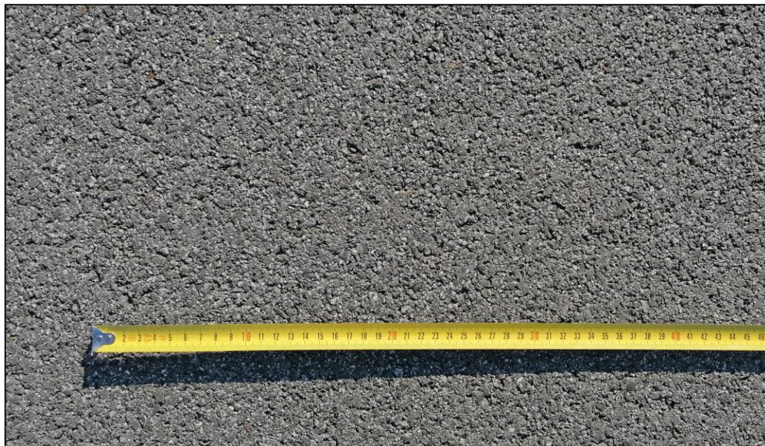
Obrázek 16: Detail povrchu zkušební dráhy – hrubý povrch
