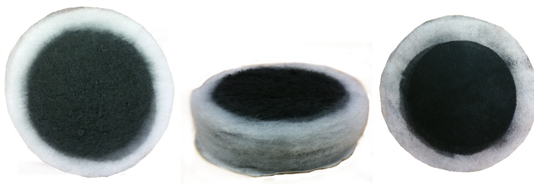
Zanesený testovaný vzorek č. 4, vpravo vrstva Spunlace
