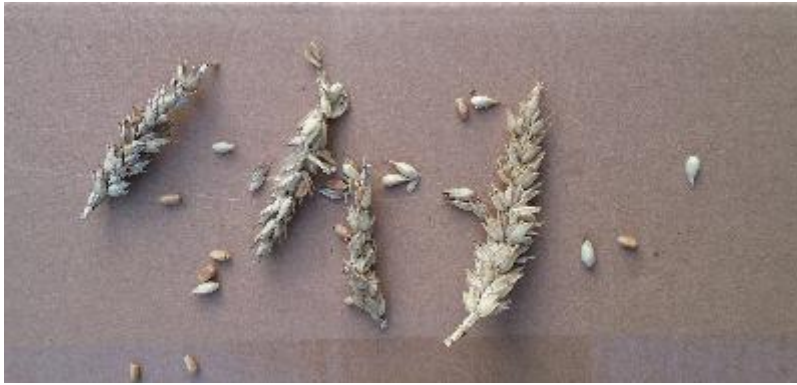
Obr. 40 Klasy po vymláčení při mezeře 25 mm
