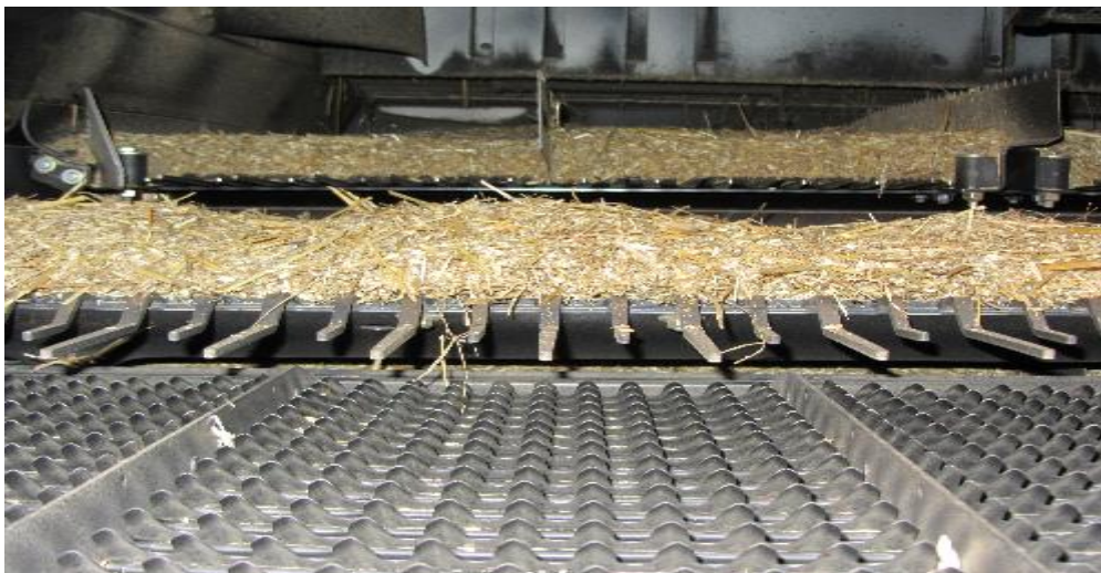
Obr. 39 Pohled na vynášecí desku při mezeře 25 mm
