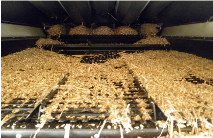
Obr. 42 Sítová skříň při kalibraci
