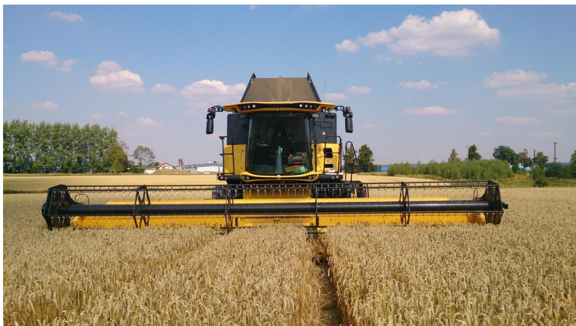
Obr. 14 Sklízecí mlátička New Holland CX 8.85 s žacím ústrojí Varifeed HD 760 CG
