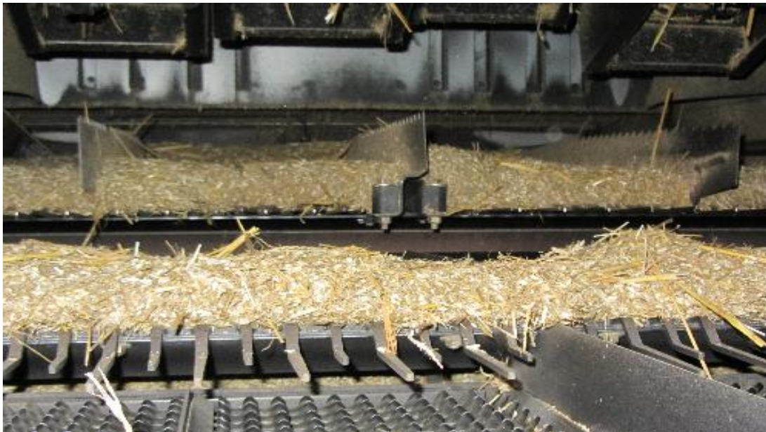
Obr. 37 Pohled na vynášecí desku při mezeře 15 mm
