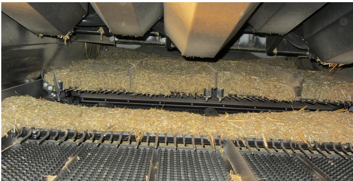
Obr. 35 Pohled na vynášecí desku při mezeře 10 mm
