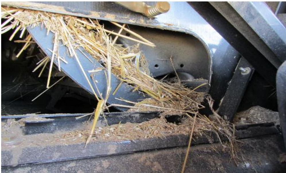
Obr. 34 Materiál mezi mláticím bubnem a mláticím košem
