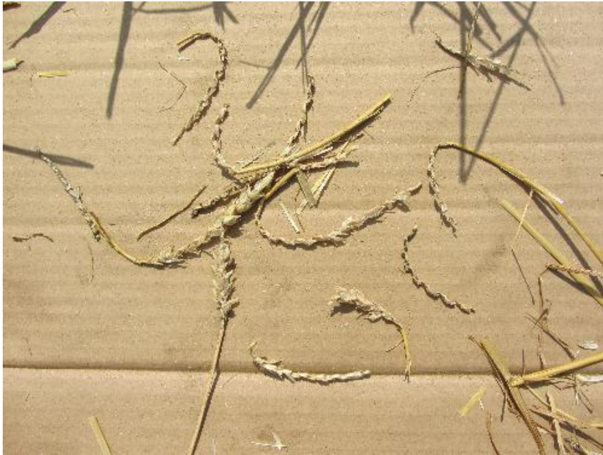
Obr. 36 Klasy po vymláčení při mezeře 10 mm
