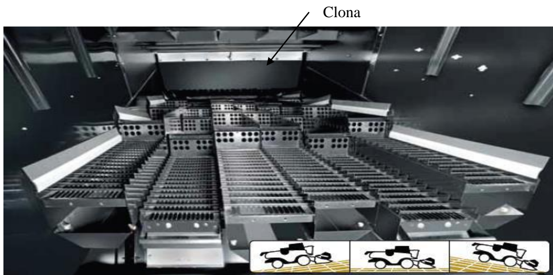
Obr. 6 Klávesové vytřasadla firmy New Holland [1]
