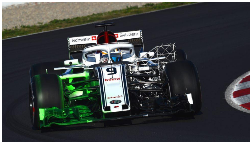
Obr. 7 Monopost Formula 1 s náterom flow-vis (vľavo) a sústavou senzorov (vpravo) [10]
