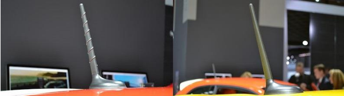
Obr. 38 Anténa použitá na verzií 500e (vľavo) a verzií 500 Lounge (vpravo) [56]
