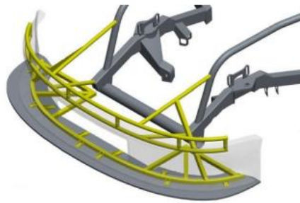
Obr. 23 Názorná poloha a umiestnenie splitteru na automobile [12]
