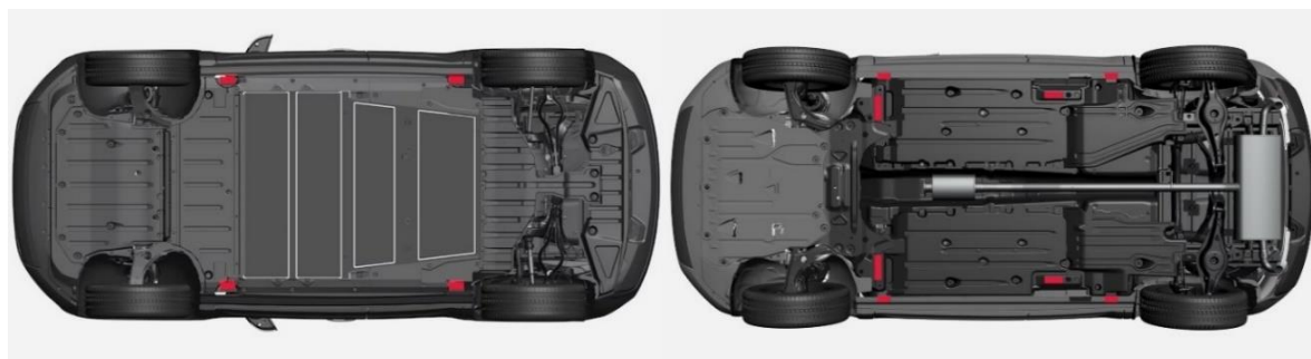
Obr. 49 Podlaha XC40 Recharge (vľavo) [59] a XC40 (vpravo) [58]
