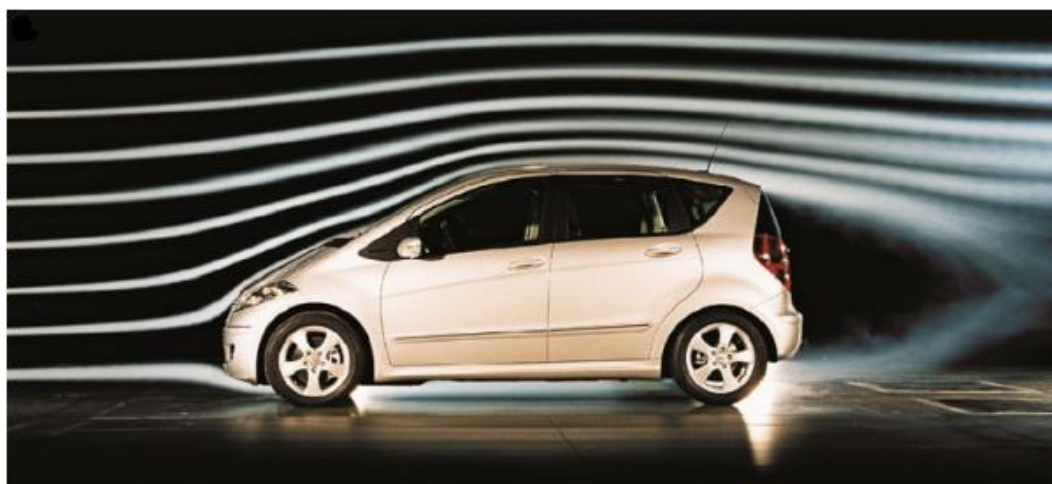
Obr. 6 Vizualizácia prúdenia vzduchu v aerodynamickom tuneli pomocou dymovej clony [8]
