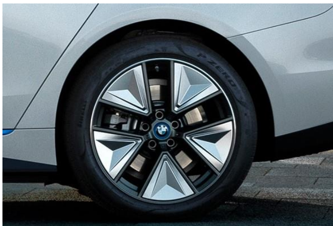
Obr. 45 Disky BMW i4 obsahujúce vnútorné vloženia [85]
