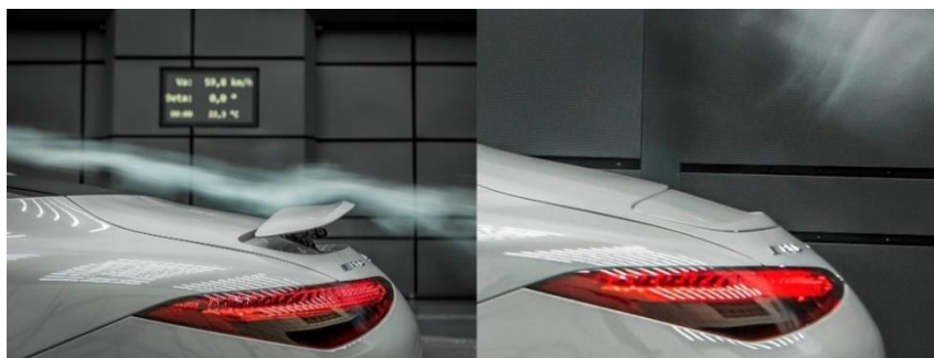
Obr. 28 Zadný spojler vozidla AMG SL vo vysunutej (vľavo) a zasunutej polohe (vpravo) [32]
