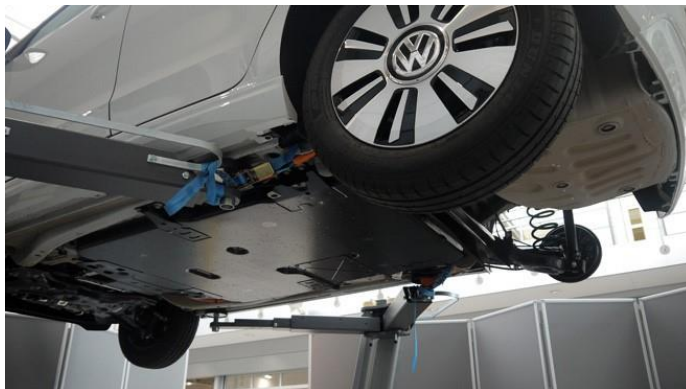
Obr. 39 Umiestnenie batérie vozidla Volkswagen e-UP! medzi nápravami [47]
