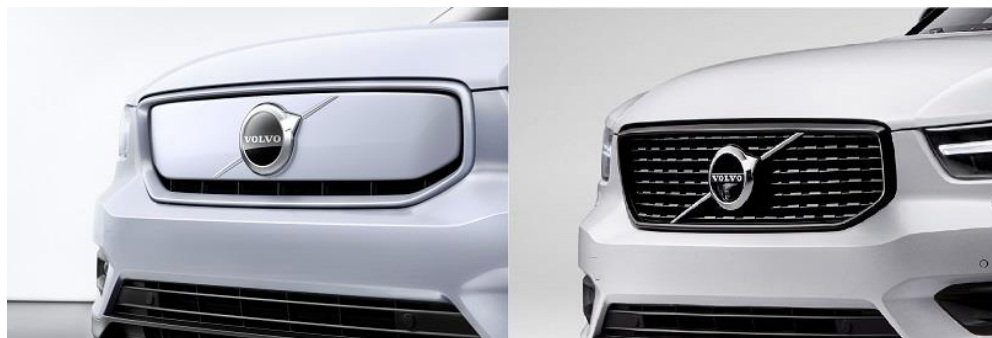
Obr. 48 Predná mriežka XC40 Recharge (vľavo) [62] a XC40 (vpravo) [61]
