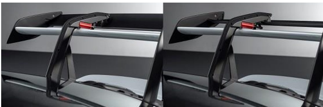
Obr. 32 Zadný spojler so zavretým (vľavo) a otvoreným (vpravo) DRS [28]
