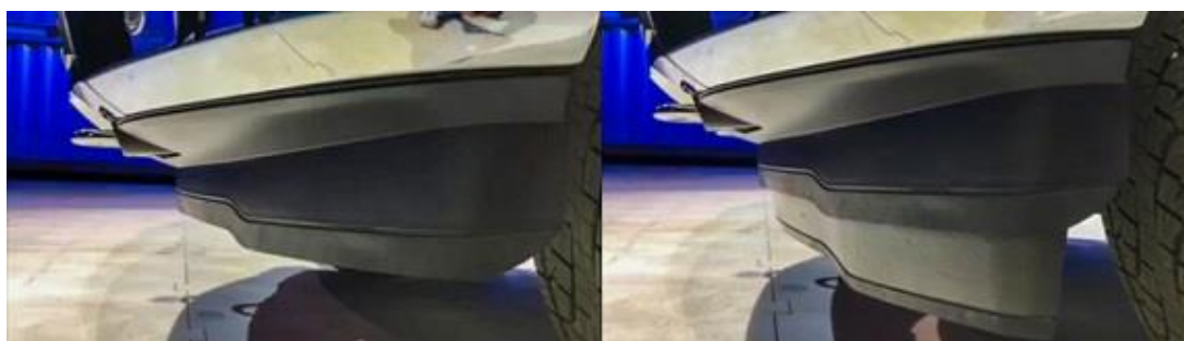
Obr. 22 Predný spojler vozidla Ford F-150 v zasunutej (vľavo) a vysunutej polohe (vpravo) [19]
