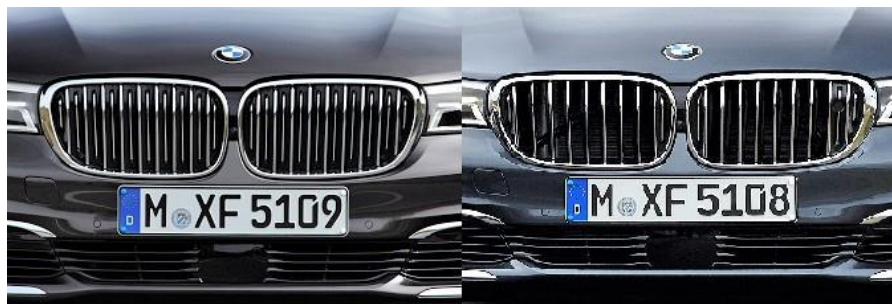
Obr. 25 Aktívne mriežky BMW 7 G12 v zatvorenej (vľavo) a otvorenej (vpravo) polohe [41]
