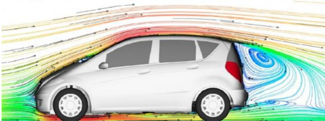
Obr. 5 Numerická CFD simulácia prúdenia vzduchu okolo vozidla Mercedes-Benz triedy A [8]
