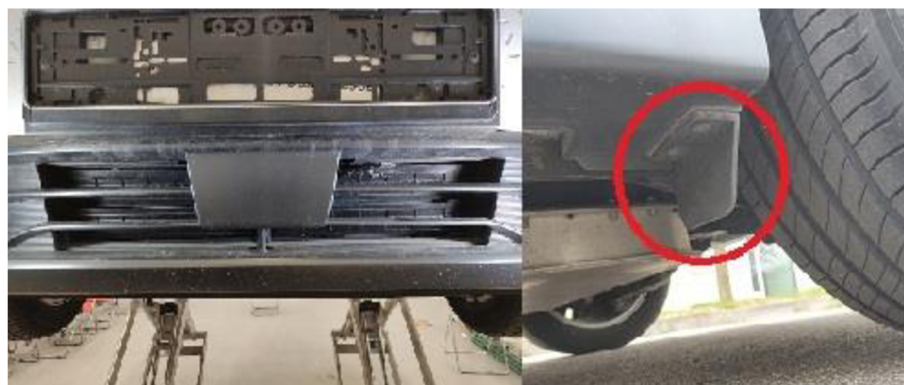
Obr. 54 Aktívne mriežky v prednej maske (vľavo) a deflektory zadných kolies (vpravo)
