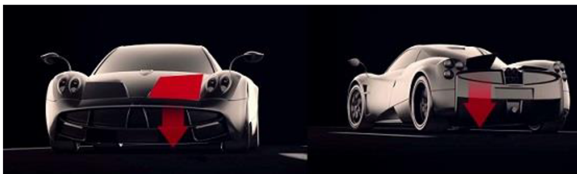
Obr. 33 Aerodynamické klapky automobilu Pagani Huayra [36]
