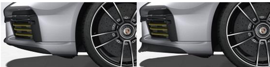
Obr. 21 Predný spojler Porsche 911 Turbo S v zasunutej (vľavo) a vysunutej polohe (vpravo) [20]
