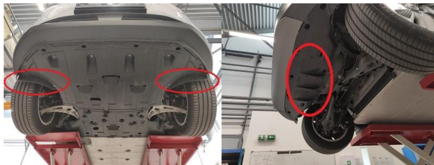
Obr. 53 Predné deflektory diskov (vľavo) a zadný difúzor (vpravo) elektromobilu Kona Electric
