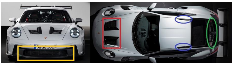
Obr. 14 Aerodynamické otvory a prvky vozidla Porsche 911 GT3 RS [28]
