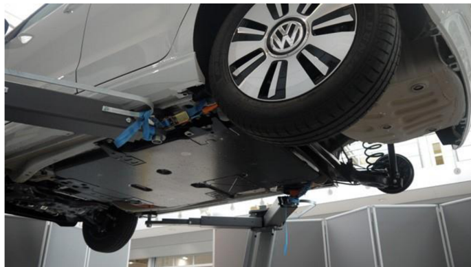
Obr. 39 Umiestnenie batérie vozidla Volkswagen e-UP! medzi nápravami [47]
