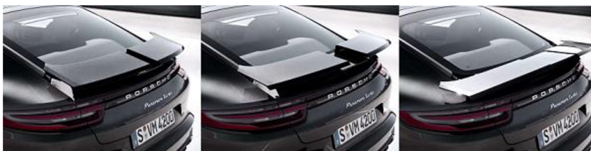
Obr. 30 Postupné vysúvanie aktívneho zadného spojleru Porsche Panamera Turbo [38]
