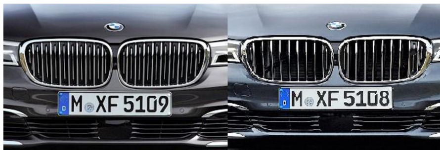
Obr. 25 Aktívne mriežky BMW 7 G12 v zatvorenej (vľavo) a otvorenej (vpravo) polohe [41]
