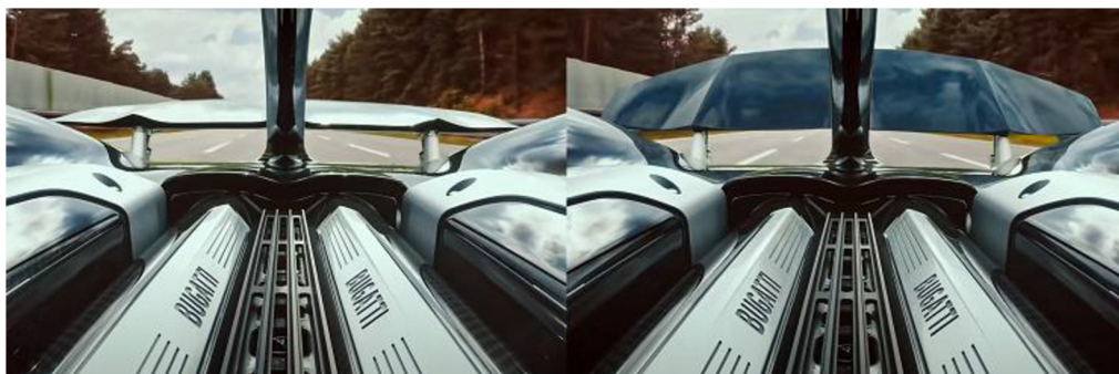
Obr. 31 Zadné krídlo Bugatti Chiron v polohe Top Speed (vľavo) a počas brzdenia (vpravo) [27]
