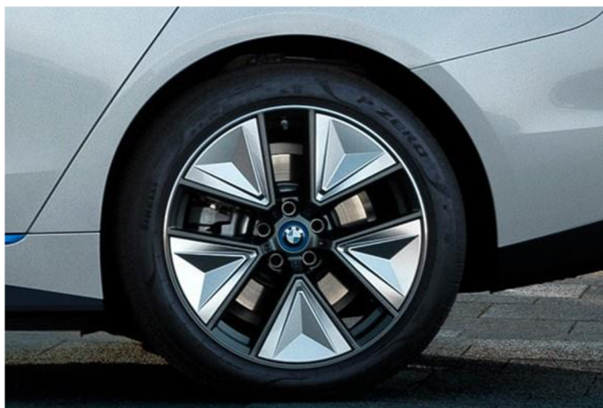
Obr. 45 Disky BMW i4 obsahujúce vnútorné vloženia [85]
