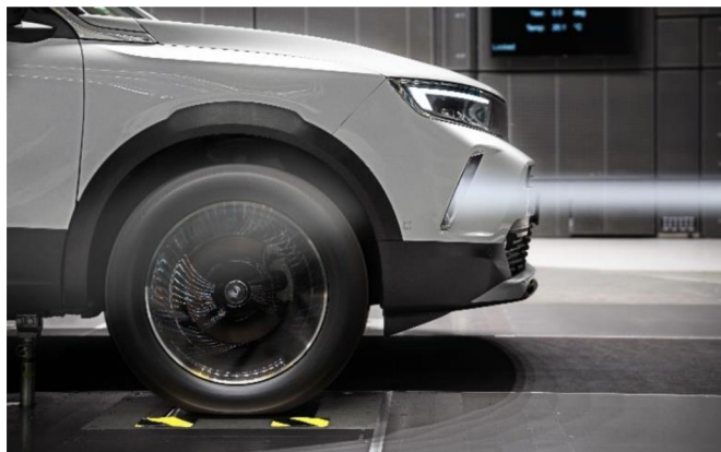
Obr. 50 Bočný otvor predného nárazníku Air Curtain vozidla Opel Mokka [44]
