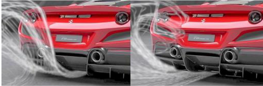
Obr. 34 Klapky difúzoru Ferrari F8 Tributo v základnej (vľavo) a aktivovanej (vpravo) polohe [22]
