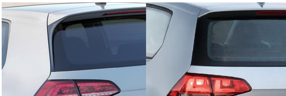
Obr. 41 Finlety v oblasti stĺpika pre e-Golf (vľavo) [52] a C stĺpik benzínovej verzie (vpravo) [53]
