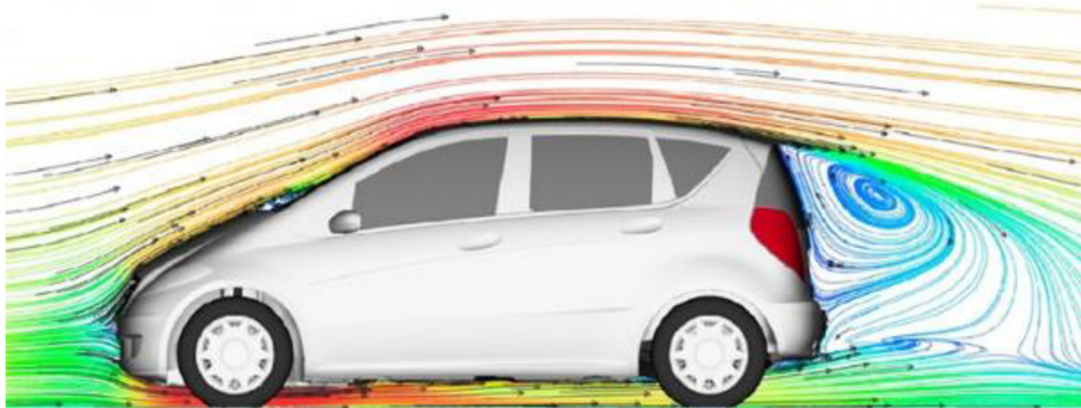
Obr. 5 Numerická CFD simulácia prúdenia vzduchu okolo vozidla Mercedes-Benz triedy A [8]
