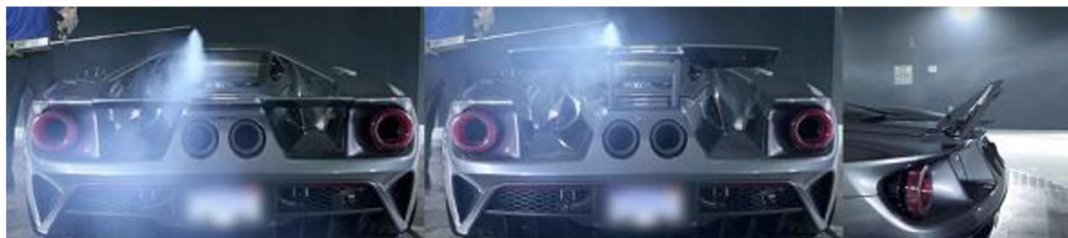
Obr. 29 Polohy spojleru Ford GT – minimálny odpor, maximálny prítlak a aerodynamická brzda [30]
