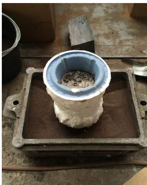
Obrázek 33. Odlitek ve skořepině po vychladnutí.
