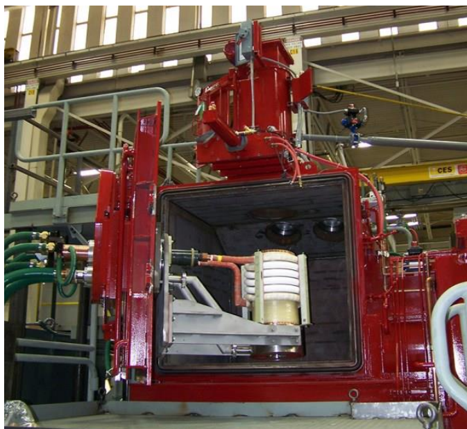
Obrázek 26. Vakuová pec s technologií ISM [48].
