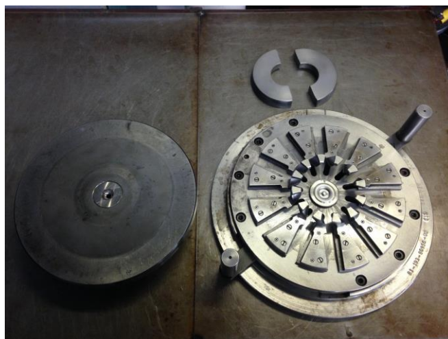
Obrázek 7. Ocelová forma turbínového kola [11].
