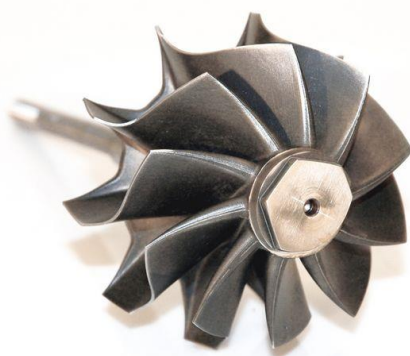
Obrázek 23. Kolo turbodmychadla ze slitiny Inconel 713LC [31].
