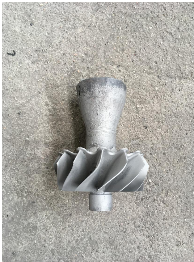
Obrázek 34. Otryskaný odlitek s nálitkem.
