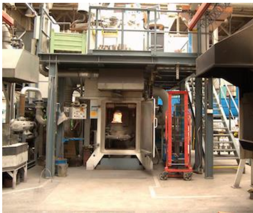
Obrázek 24. Vakuová Indukční pec ve firmě PBS [44].
