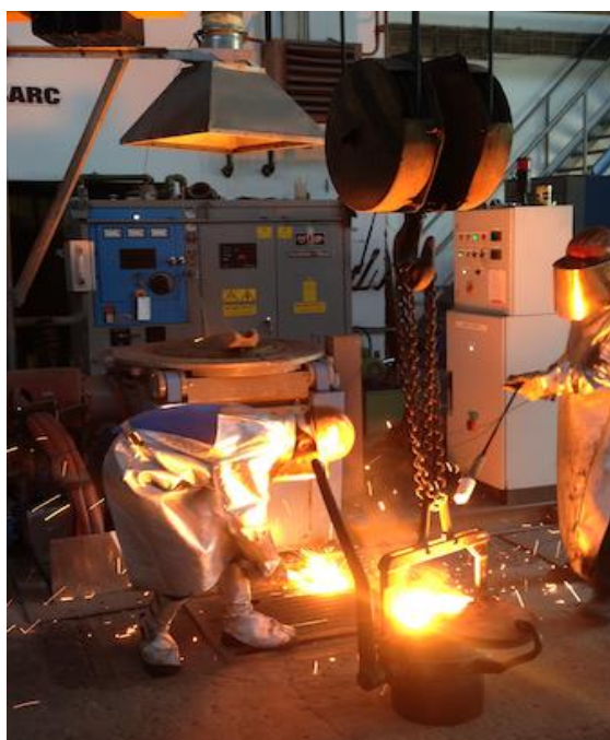
Obrázek 31. Stažení strusky a měření teploty.
