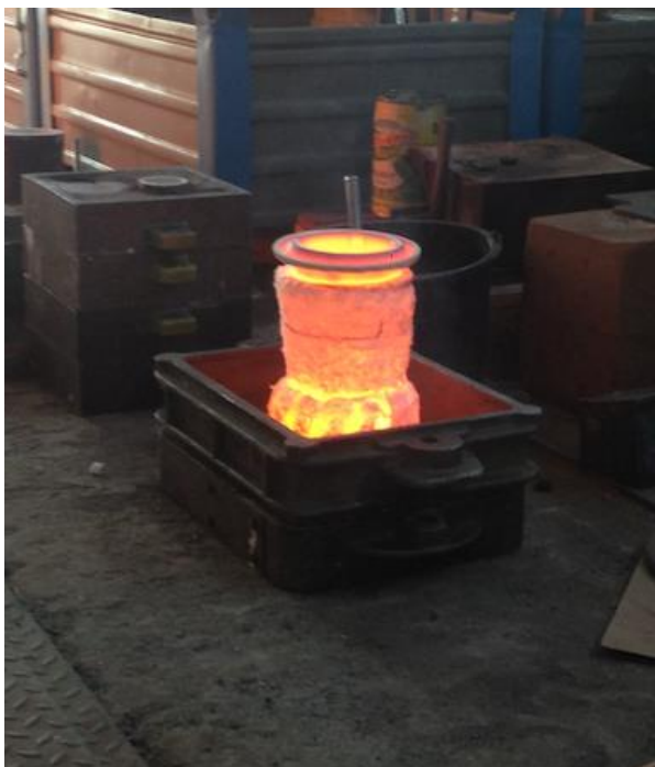
Obrázek 29. Vyžháná skořepina připravená k odlévání.
