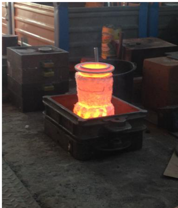
Obrázek 29. Vyžháná skořepina připravená k odlévání.
