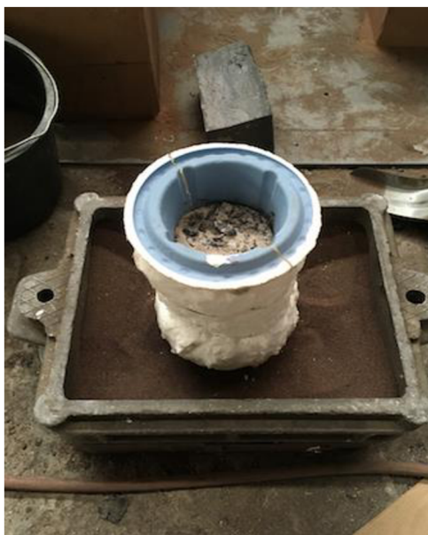
Obrázek 33. Odlitek ve skořepině po vychladnutí.
