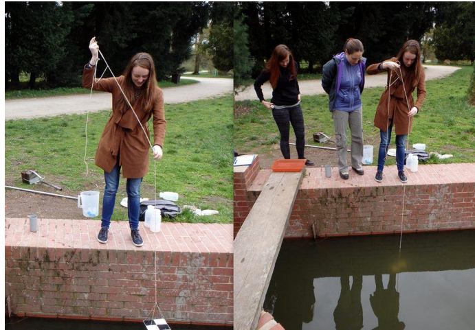
Obrázek 6: Stanovení průhlednosti vody Secciho deskou.
