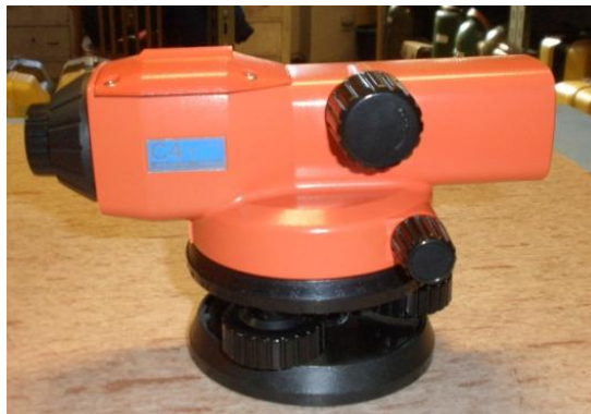
Obr. 3.5 Nivelační přístroj Sokkia C004
