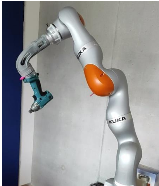
Obrázek 9: Namontována pomocná konstrukce. Zdroj: autor.
