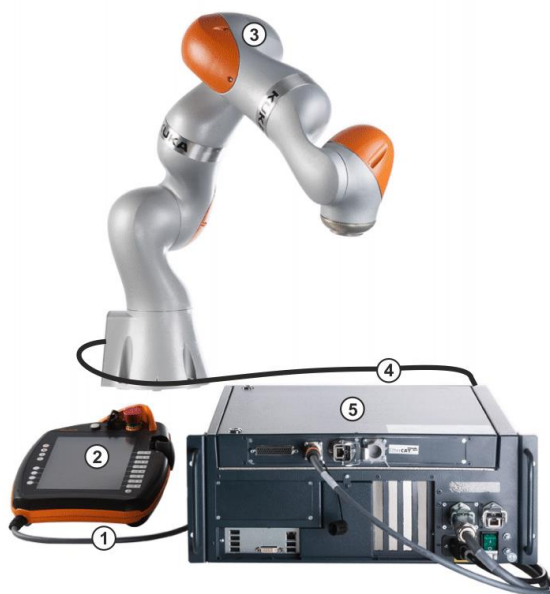
Obrázek 7: Robot KUKA LBR iiwa a jeho součásti (KUKA ROBOTER, 2015, s.9)
