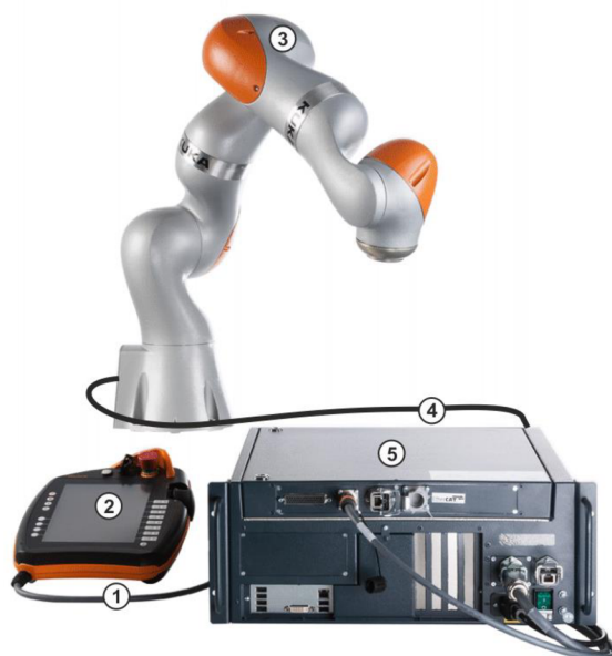
Obrázek 7: Robot KUKA LBR iiwa a jeho součásti (KUKA ROBOTER, 2015, s.9)
