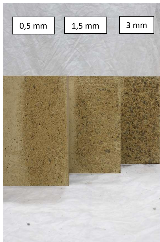
Obr. 47 Vymytí povrchů Receptury II
