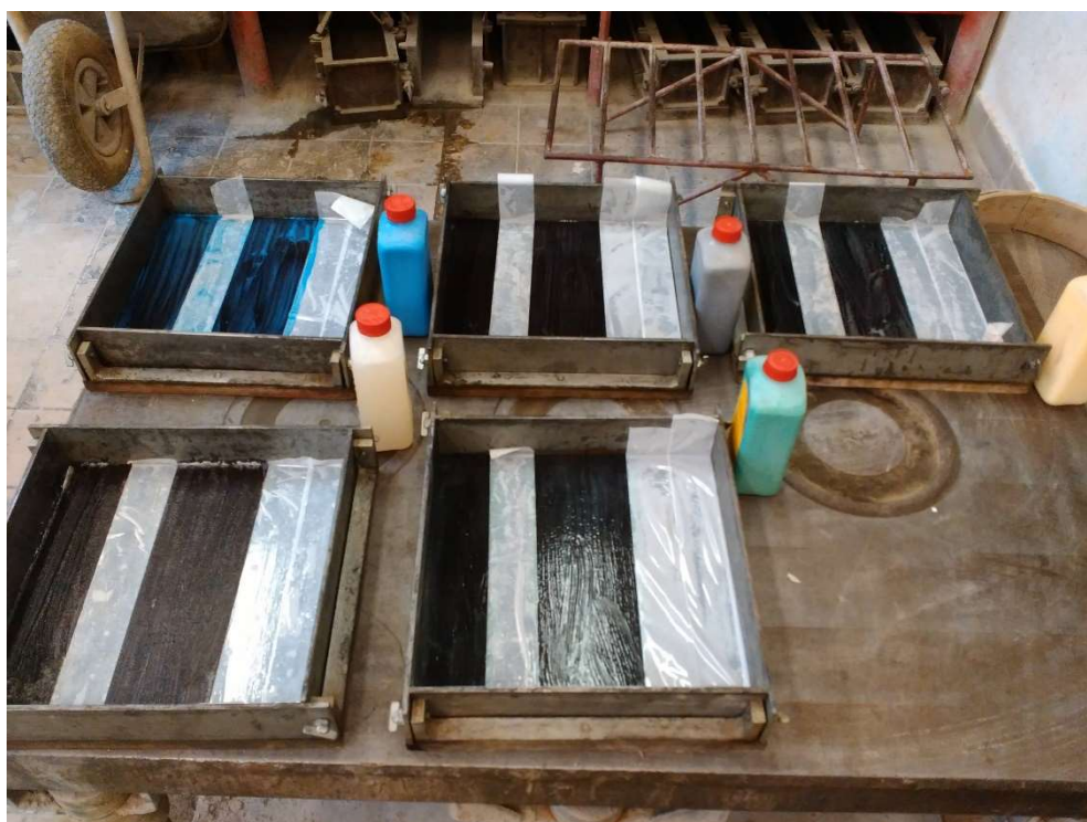
Obr. 15 Nanesení zpomalovačů tuhnutí na bedně
