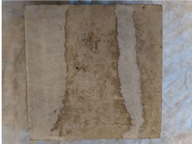
Obr.19 Povrch betonu opatřený zpomalovačem tuhnutí VP 70
