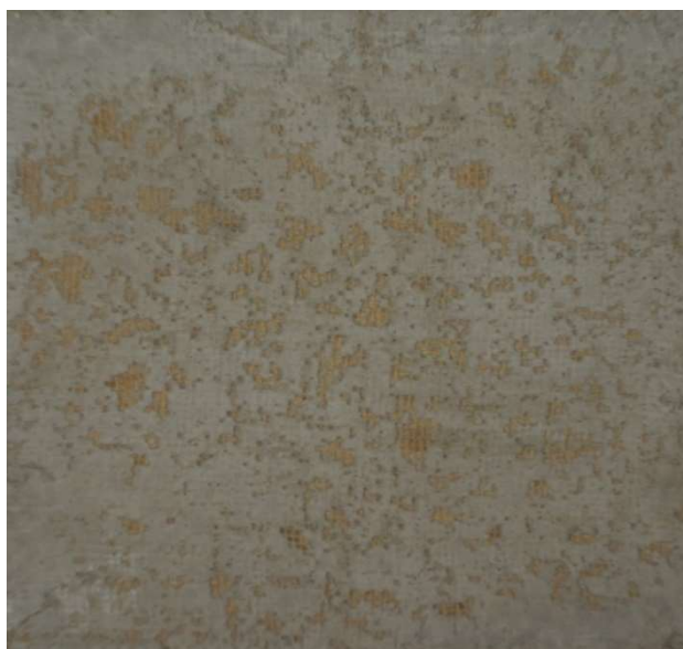
Obr. 25 Betonový povrch s jutovou vložkou pro Recepturu I
