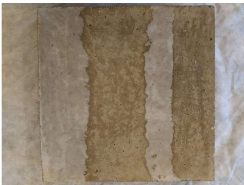
Obr. 18 Povrch betonu opatřený zpomalovačem tuhnutí VP 25
