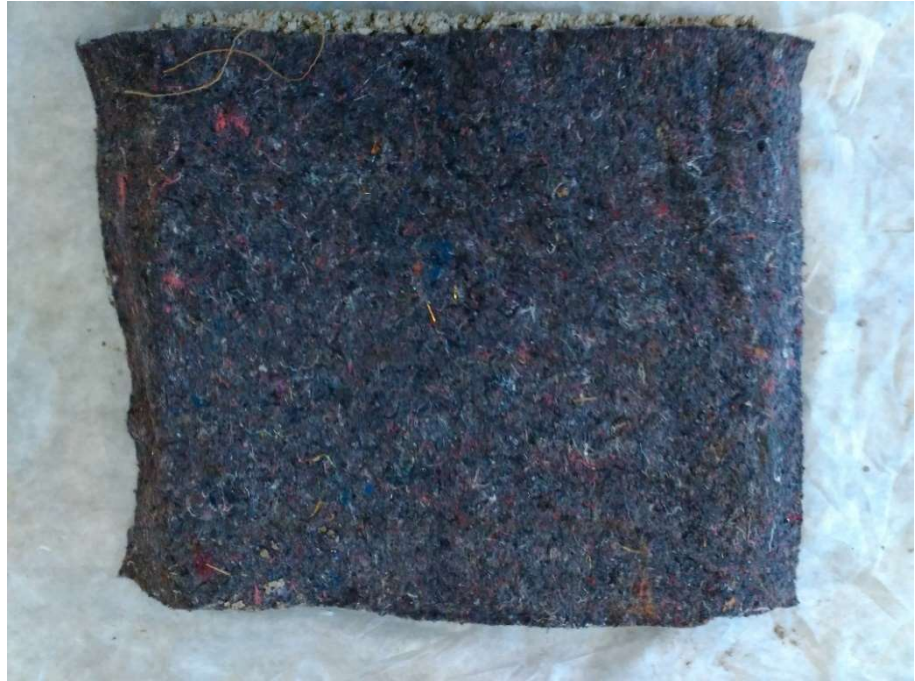
Obr. 40 Povrch betonu s rounovou vložkou ve vertikální poloze pro Recepturu I
