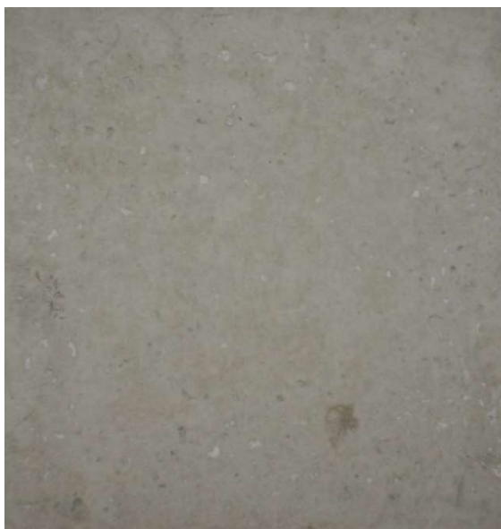
Obr. 29 Betonový povrch s netkanou textilní vložkou pro Recepturu I
