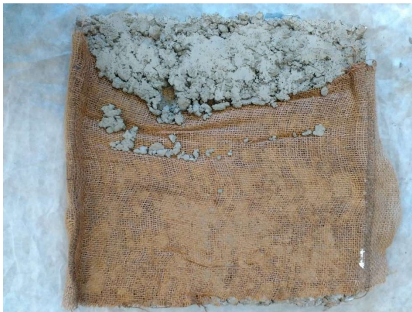
Obr. 37 Povrch betonu s jutovou vložkou ve vertikální poloze pro Recepturu I
