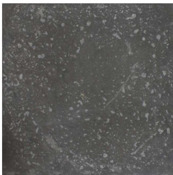
Obr. 31 Betonový povrch s netkanou textilní vložkou pro Recepturu III
