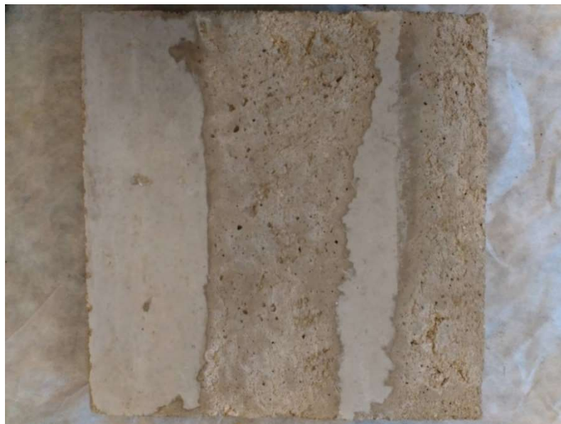
Obr. 20 Povrch betonu opatřený zpomalovačem tuhnutí Microgel
