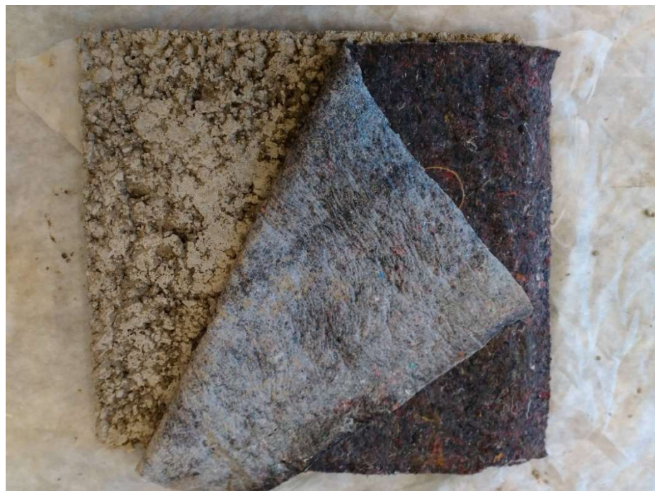
Obr. 41 Povrch betonu s odhalenou rounovou vložkou ve vertikální poloze pro Recepturu I
