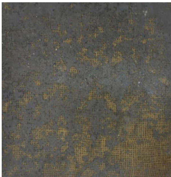
Obr.27 Betonový povrch s jutovou vložkou pro Recepturu III
