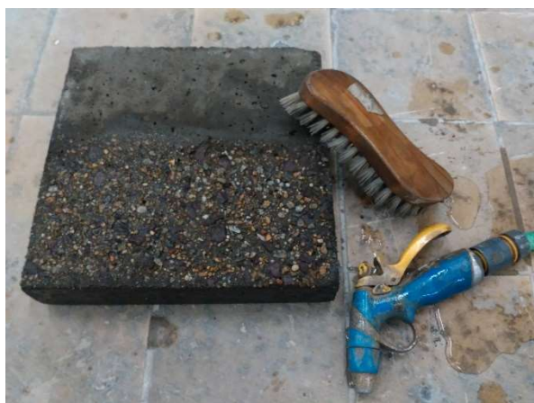
Obr. 45 Vykartáčovaný povrch vymytý pomocí vodní pistole
