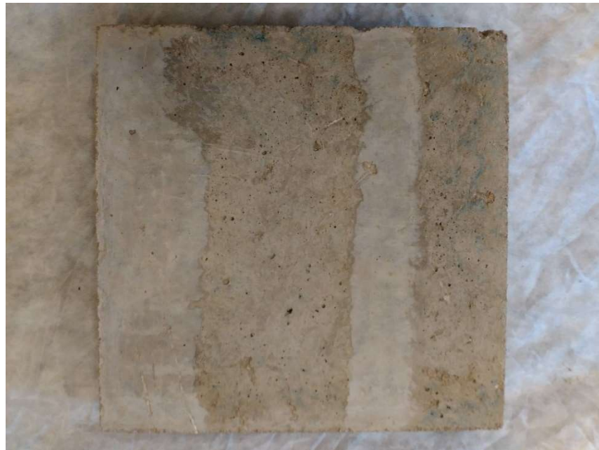
Obr.16 Povrch betonu opatřený zpomalovačem tuhnutí VP 01
