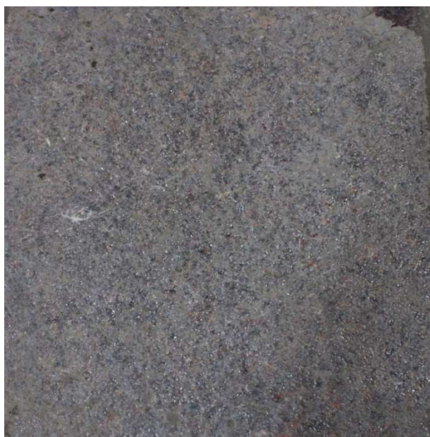
Obr. 35 Betonový povrch s rounovou vložkou pro Recepturu III
