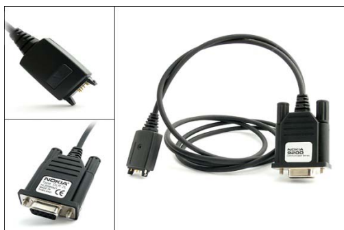
Obr. 2.1: Příklad datového kabelu s rozhraním RS232 od společnosti NOKIA
