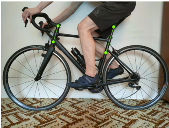
Obr. 5.2: Znázornenie bodov, ktoré musia užívatelia zadať, aby aplikácia mala znalosť o vektoroch posunu sedlovky a hlavového zloženia
