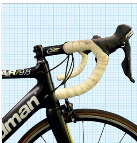
Obr. 2.3: Riadidlá a brzdové páčky s bežným sklonom [18]. Kontaktná plocha na vrchu riadidiel je približne vodorovná.
