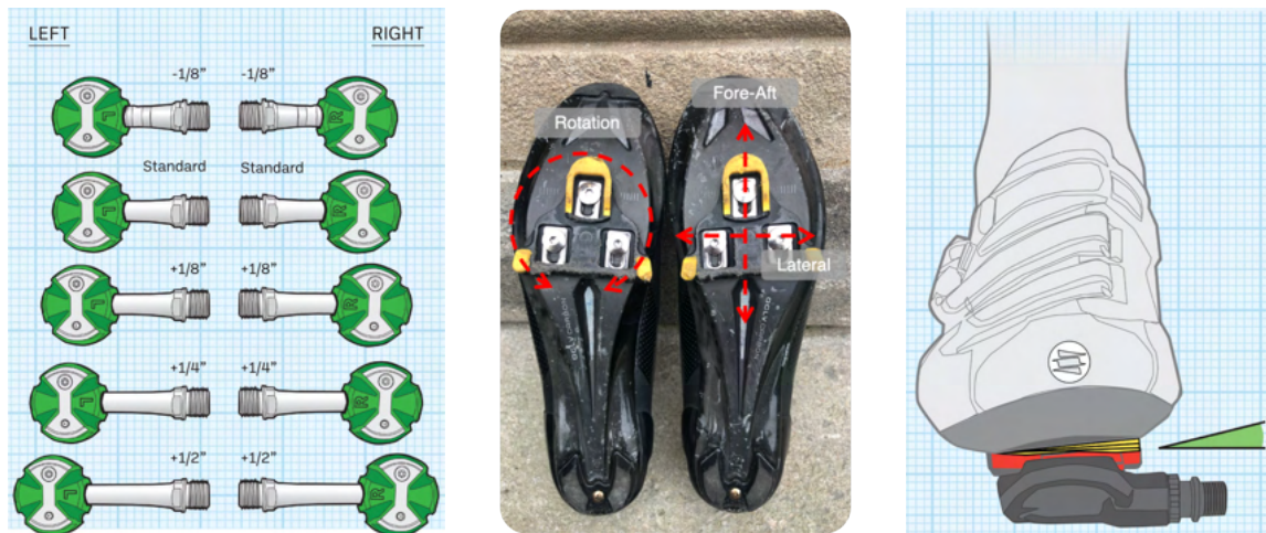
Obr. 2.2: Zľava doprava - Osky pedálov rôznych dĺžok [18]. Možnosti nastavenia kufrov na pedáloch [22]. Žltou farbou naznačená podložka medzi kufrom a treťou [18].
