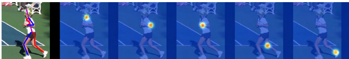
Obr. 3.3: Heatmapy generované modelom Stacked Hourglass pre každý kľúčový bod [34].
