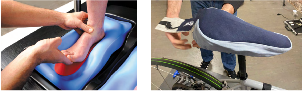
Obr. 2.6: Forma na meranie klenby chodidiel (vľavo) [43]. Prikrývka sedla merajúca tlak sedacích kostí (vpravo) [9].
