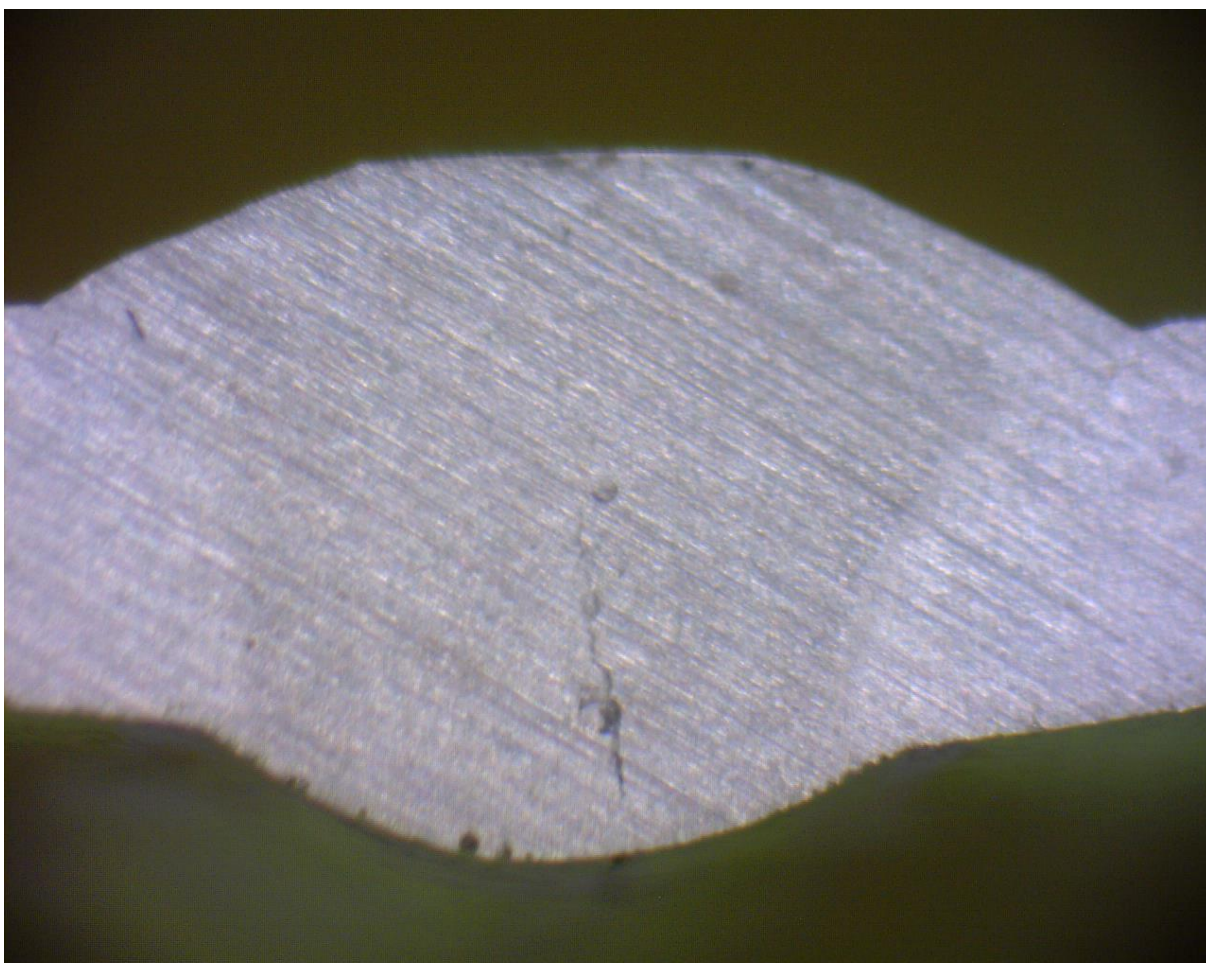
Obr. 27 Detail svaru plechů tloušťky 0,98 mm
