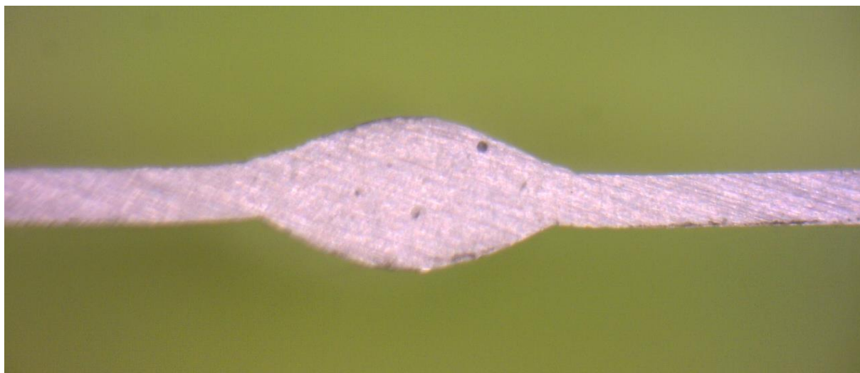
Obr. 23 Řez svarem plechů tloušťky 0,51 mm
