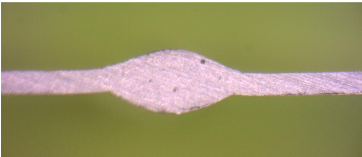
Obr. 23 Řez svarem plechů tloušťky 0,51 mm
