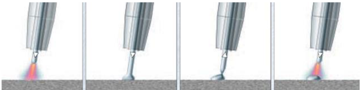
Obr. 13 Dynamický pohyb drátu při svařování metodou CMT [2,17]
