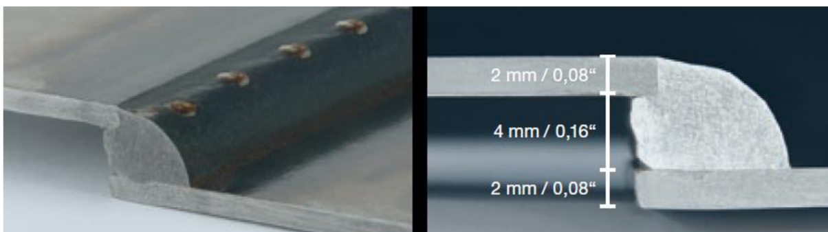
Obr. 33 Spára mezi ocelovými plechy přemostěná svarem [4]
