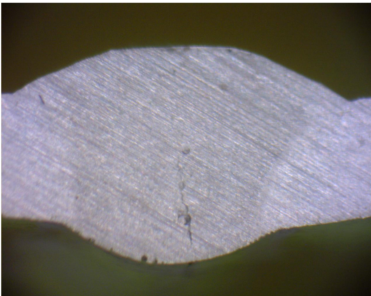
Obr. 27 Detail svaru plechů tloušťky 0,98 mm
