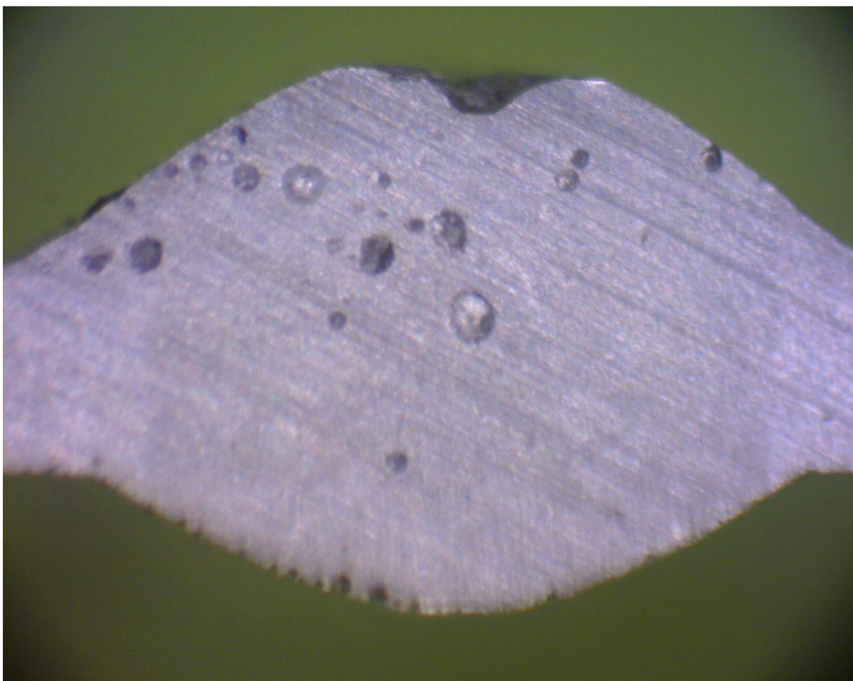
Obr. 21 Detail svaru plechů tloušťky 0,29 mm
