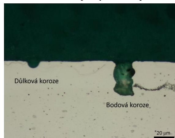
Obr. 12 Důlková a bodová koroze [34]
