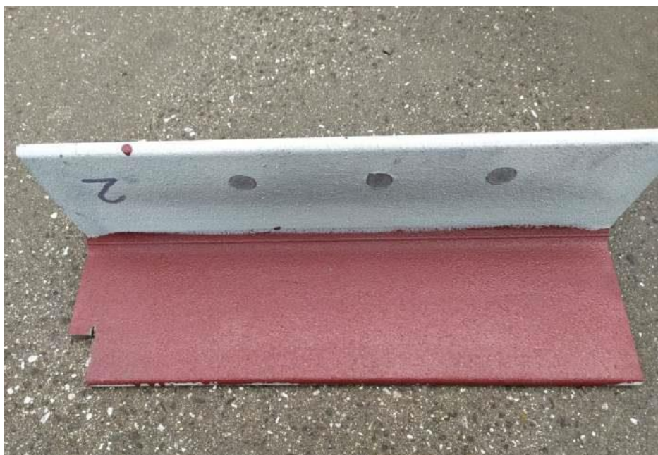
Obr. 78 Nanesená vrstva nátěru na povlaku Zinacor 850
