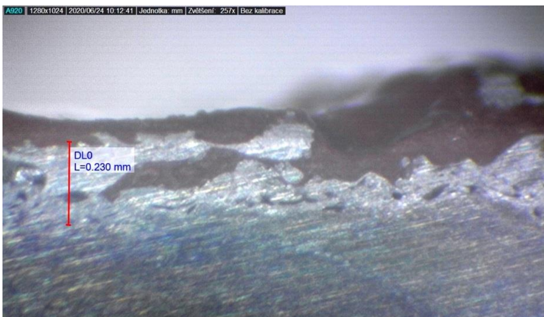
Obr. 81 Snímek, zobrazující velký pór povlaku – vzorek č. 2
