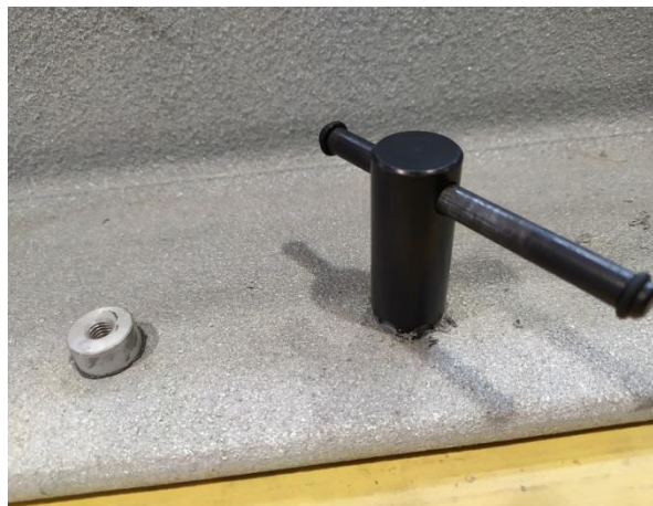
Obr. 55 Proříznutí okolí terče ruční frézou
