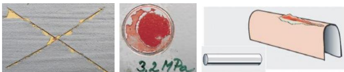
Obr. 30, 31 a 32 Zkouška X-řezem, Odtržená plocha, Ohyb přes válcový trn [23]
