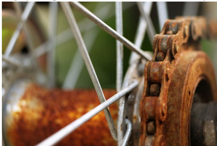
Obr. 8 Ukázka koroze zadního náboje bicyklu [27]
